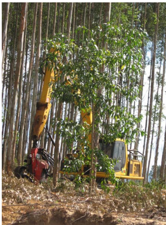
Foto 04: Máquina que acumula função de corte, descascagem, modelação e empilhamento da madeira. Arquivo Adilson P. de Oliveira Jr., 2008.
