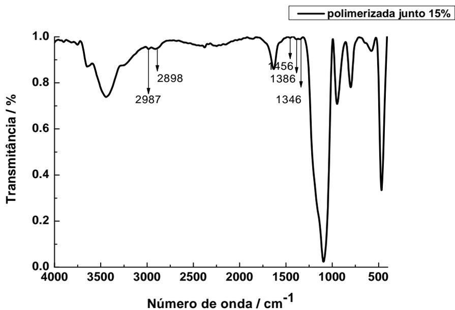
**Figura 25.** Espectro vibracional no IV, da sílica polimerizada com 15% em mol de modificador apenas misturado ao meio reacional.
