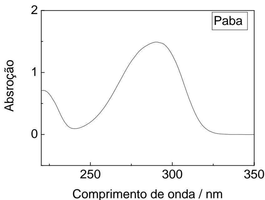
**Figura 19.** Espectros eletrônicos de absorção do PABA medidos através da transmitância tendo utilizando solução etanólica.
