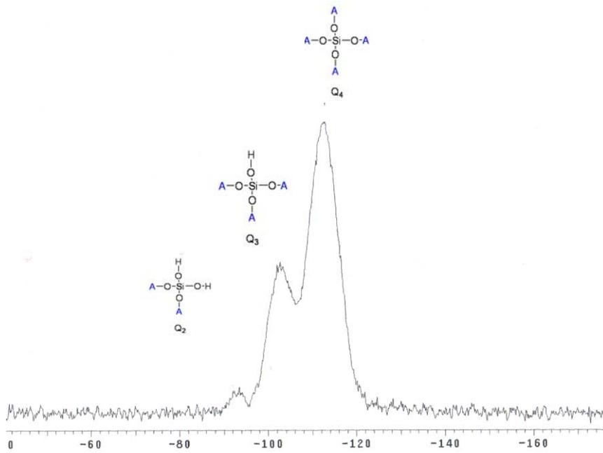
**Figura 33.** Espectro de RMN da amostra de sílica misturada com 15% em mol de modificador e seca a 100 °C
