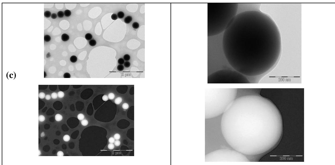
**Figura 12.** Fotomicrografias das partículas de  $\text{SiO}_2$  (a)  $\text{H}_2\text{O} : \text{NH}_4\text{OH} = 2,5$  (b)  $\text{H}_2 : \text{NH}_4\text{OH} = 1,5$ , (c)  $\text{H}_2\text{O} : \text{NH}_4\text{OH} = 0,52$
