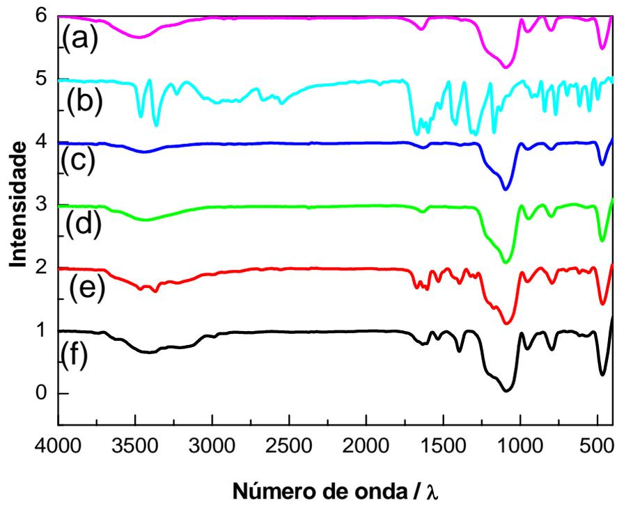
**Figura 17.** Espectros vibracionais no IV (a) SiO<sub>2</sub>, (b) PABA, (c)25% de PABA S.E, (d) 50% de PABA S.E , (e) 50% de PABA S.D, (f) 25% de PABA S.D.
