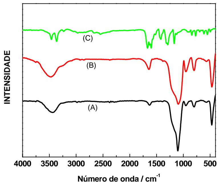
**Figura 21.** Espectros vibracionais no IV (a) SiO<sub>2</sub> com PABA, (b) SiO<sub>2</sub> puro, (c) PABA.
