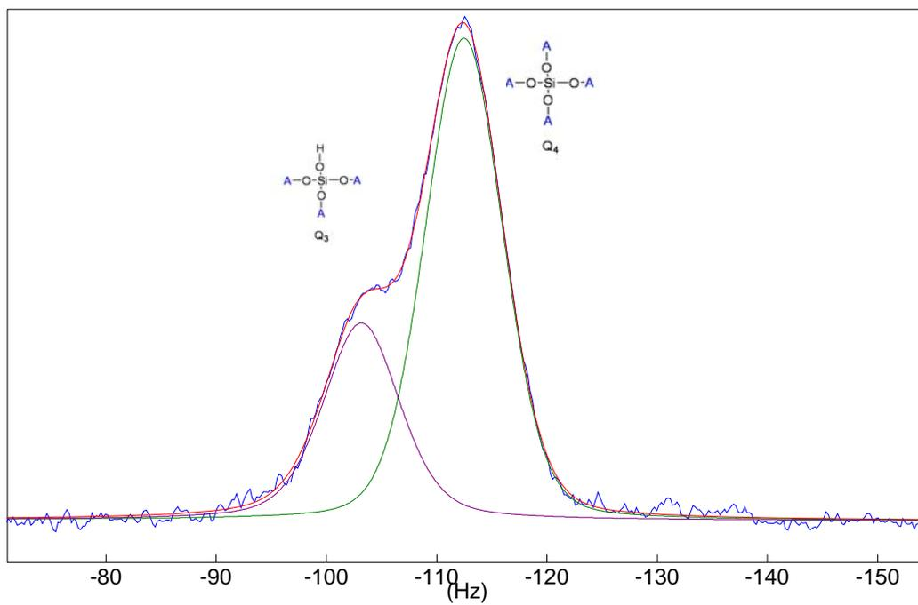
**Figura 14.** Ressonância magnética nuclear da amostra obtida na condição 3, com tamanho médio em torno de 100 nm.
