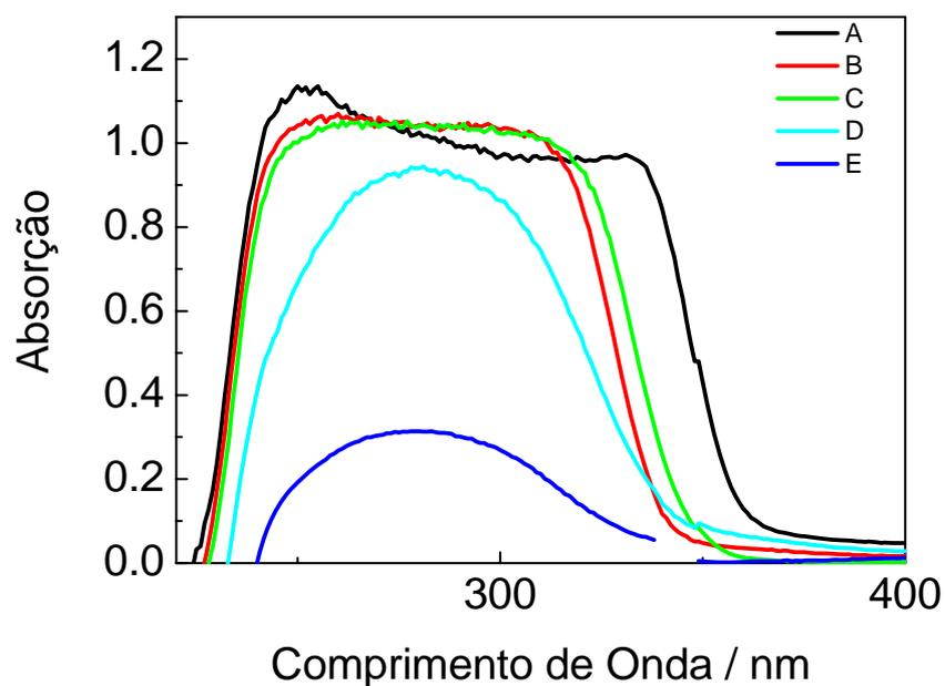
**Figura 18:** Espectros eletrônicos de absorção das amostras obtidos através da refletância tendo MgO como branco: (A) PABA, (B) 25% de PABA S.D., (C) 50% de PABA S.D., (D)50% de PABA S.E, (E)25% de PABA S.E..
