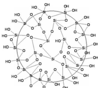
Essa seria a estrutura de uma partícula de sílica no seu ponto isoelétrico, carga nula, no qual todos os silanóis então protonados.
