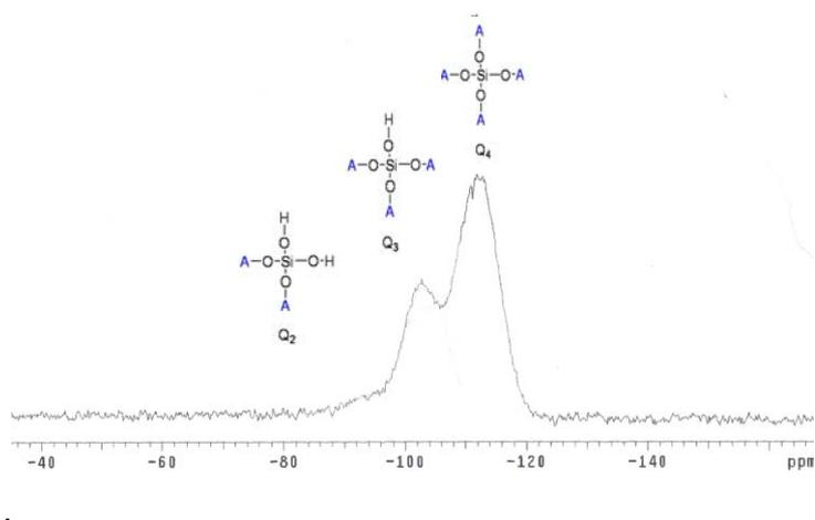
**Figura 31.** Ressonância magnética nuclear da amostra com pré-hidrolise 72h.
