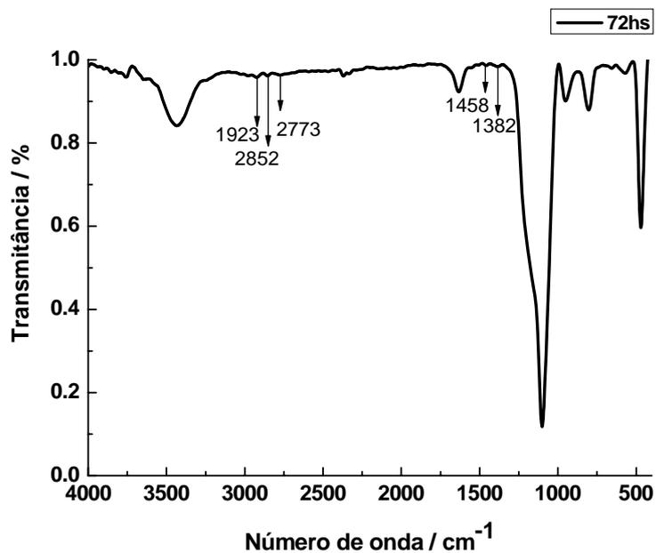
**Figura 24.** Espectro vibracional no IV, sílica funcionalizada com modificador com pré-hidrólise deixada em refluxo por 72 h.
