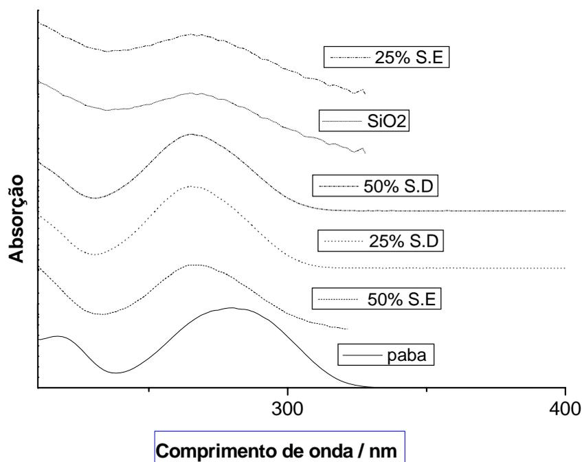
**Figura 20.** Espectros eletrônicos de absorção no UV-Vis das amostras, medidos através da transmitância, em escalas diferentes na ordenada: PABA, 25 e 50% S.E. e S.D. e SiO<sub>2</sub>.
