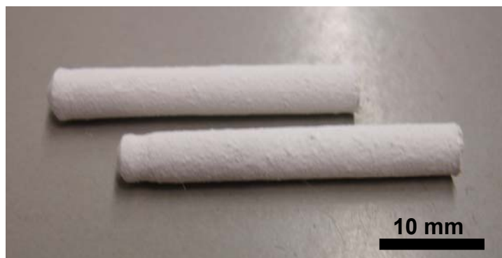
Figura 4.11 - Detalhe do protótipo do sensor a verde conformado por prensagem isostática.
