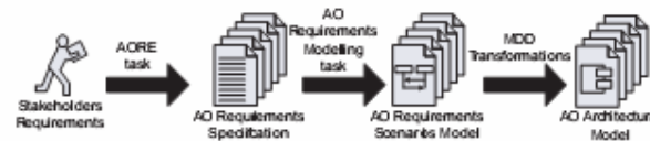
Figura 46: Representação da transformação automática de um modelo de requisitos orientados a aspectos para um modelo de arquitetura orientada a aspectos
