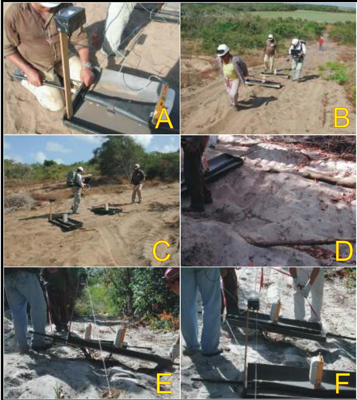
Figura 4.15 – Aquisição dos perfis de reflexão com GPR na etapa 2006. (A) acoplamento das hastes complementares da antena de 50MHz; (B,C) aquisição no modo contínuo; (D,E,F) presença de tocos e raízes no meio da linha, o que pode gerar problemas no radargrama devido o desacoplamento das antenas ao solo.
