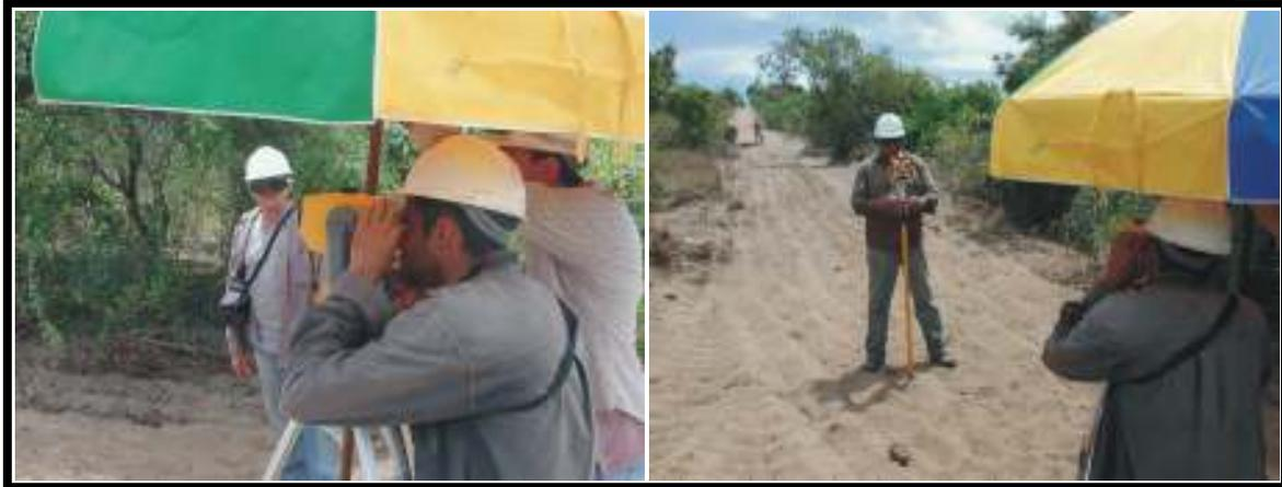
Figura 4.8 – Levantamento topográfico com a Estação Total Trimble 3305 DR.
