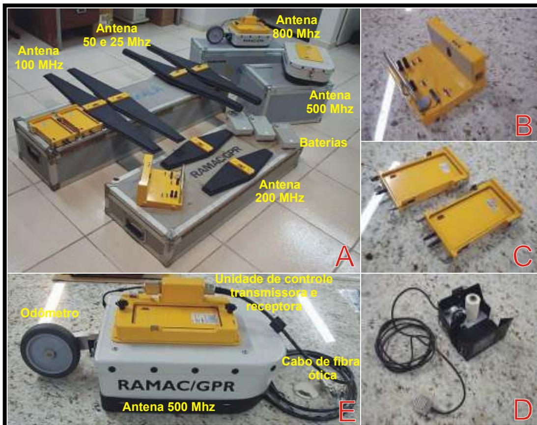
Figura 4.13 – (A) GPR RAMAC; (B) Unidade de controle central; (C) Unidades eletrônicas transmissora e receptora; (D) odômetro das antenas de 50, 100 e 200 MHz; (E) antena de 500 MHz e respectivos acessórios.
