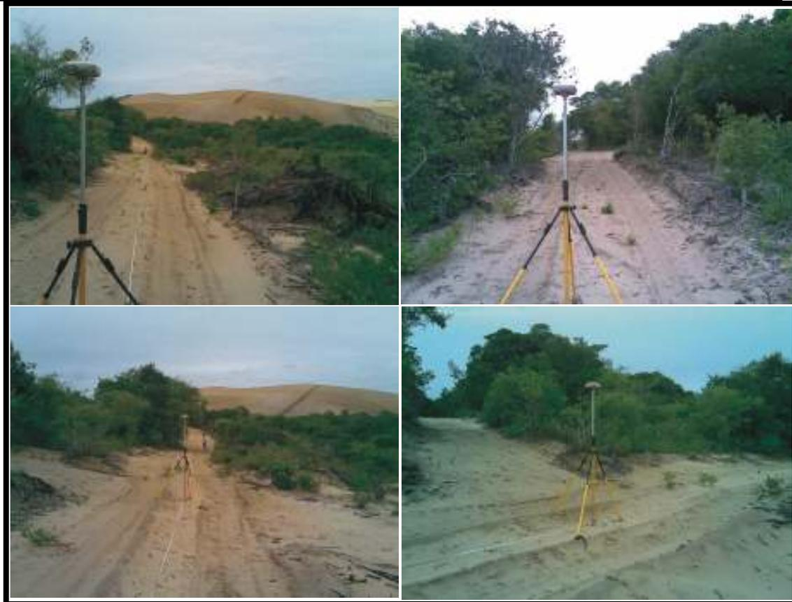
**Figura 4.11 – Levantamento planialtimétrico da linha transversal com GPS Geodésico. Levantamentos estáticos com receptor móvel “Hiper”. A ocupação por ponto variou entre 2 e 4 minutos, com uma taxa de gravação de 1 segundo.**
