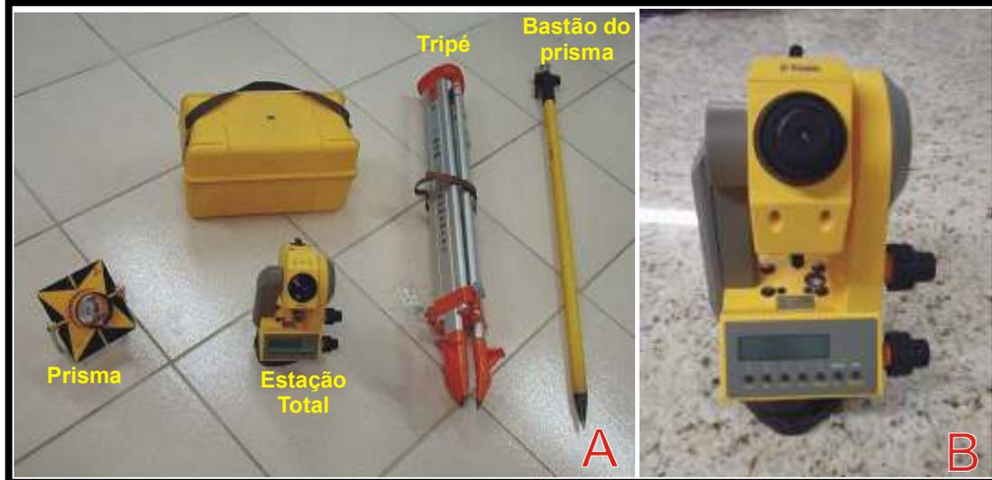
Figura 4.6 – (A) Conjunto da Estação Total Trimble 3305 utilizada na campanha de 2006; (B) visão mais aproximada da Estação Total.
