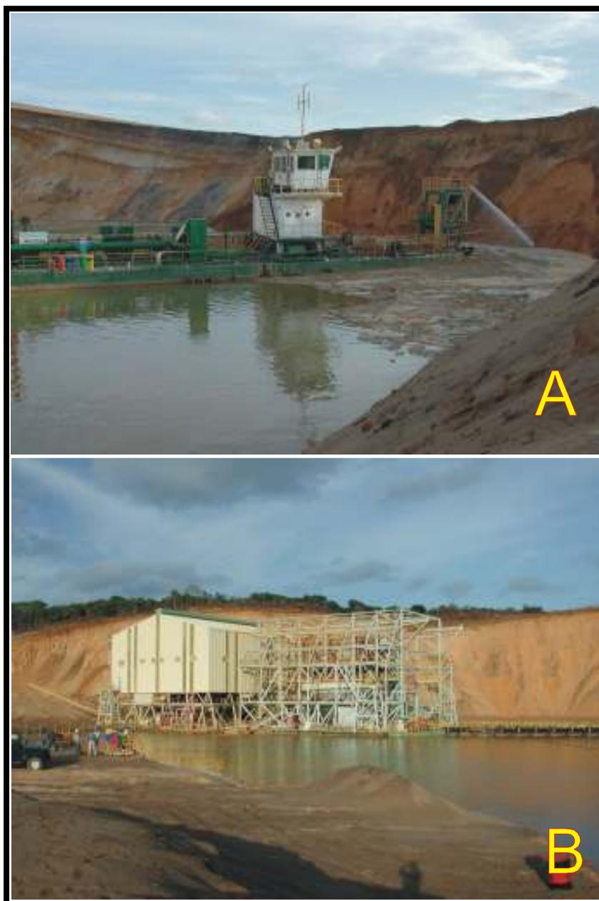
**Figura 4.2 – Lavra por dragagem. (A) Drega efetuando desmonte da bancada de areia com jatos de água. (B) Planta de Concentração.**
