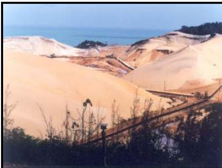
Figura 4.1 – Lavra seca mecanizada. As areias das dunas eram conduzidas após o desmonte por extensas esteiras até chegar nas plantas de beneficiamento.
