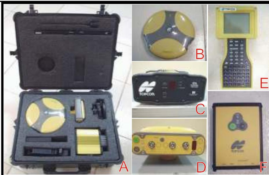
Figura 4.9 – (A) GPS Geodésico dupla frequência da TOPCON; (B) antena Legant 2 do receptor Base; (C) rádio transmissor do receptor Base (fixo); (D) receptor rover Hiper GGD; (E) coletor de dados; (F) receptor Base Legacy H-GD.
