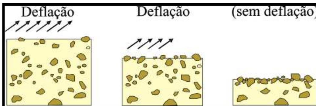
Figura 2.1 - Três estágios de desenvolvimento de um pavimento de deflação: deflação inicial dos sedimentos arenosos; concentração dos clastos a medida que ocorre a deflação; o término da deflação em decorrência do recobrimento total do substrato arenoso por clastos. Modificado de Greeley & Inversen, 1985.
