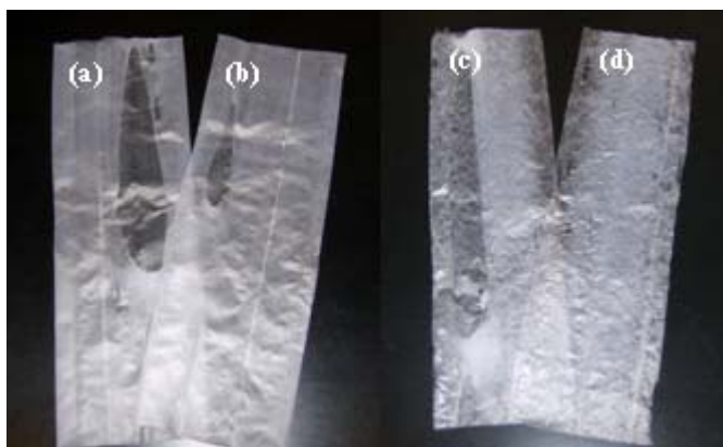
Figura 4.18 Filmes das blendas de PEAD/EVA (50 \mu m de espessura) obtidos em diferentes condições de processamento. Blenda PEAD/EVA 8: (a) 65 rpm / BUR = 1,0 / TUR = 18,5; (b) 40 rpm / BUR = 1,0 / TUR = 18,5. Blenda PEAD/EVA 25: (c) 65 rpm / BUR = 1,0 / TUR = 18,5, (d) 40 rpm / BUR = 1,0 / TUR = 18,5.
