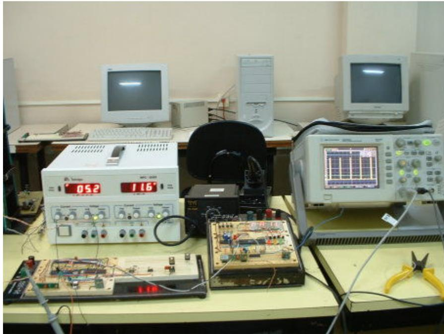
**Figura 45 - Foto da Bancada de Teste das unidades de aquisição e leitura.**
