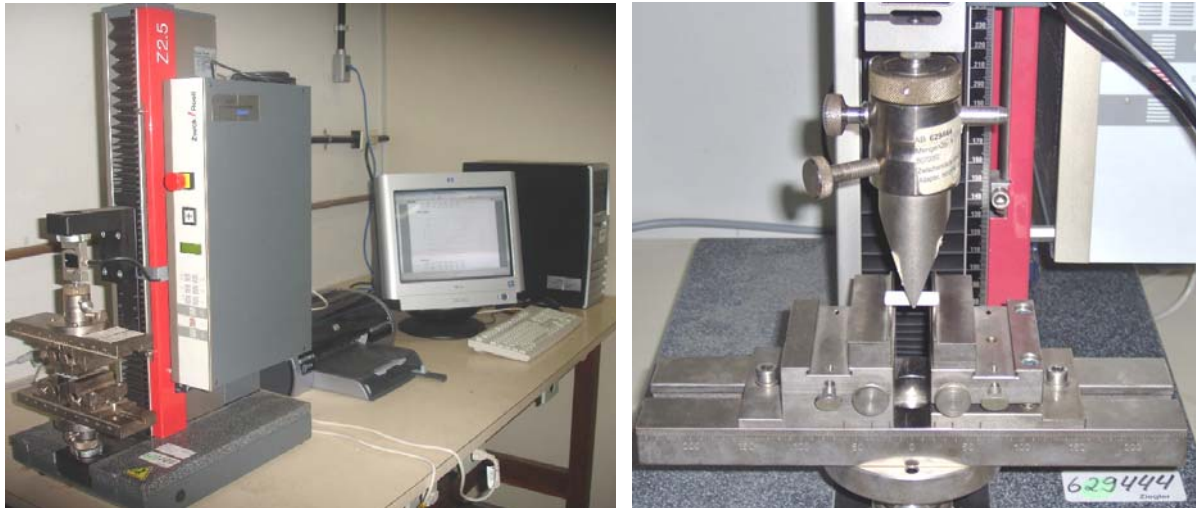
Figura 7. (a) –Máquina Zwick/Roel Z2.5 para ensaios mecânicos. (b) – Detalhe do dispositivo na realização de ensaio de flexão em 3 pontos.
