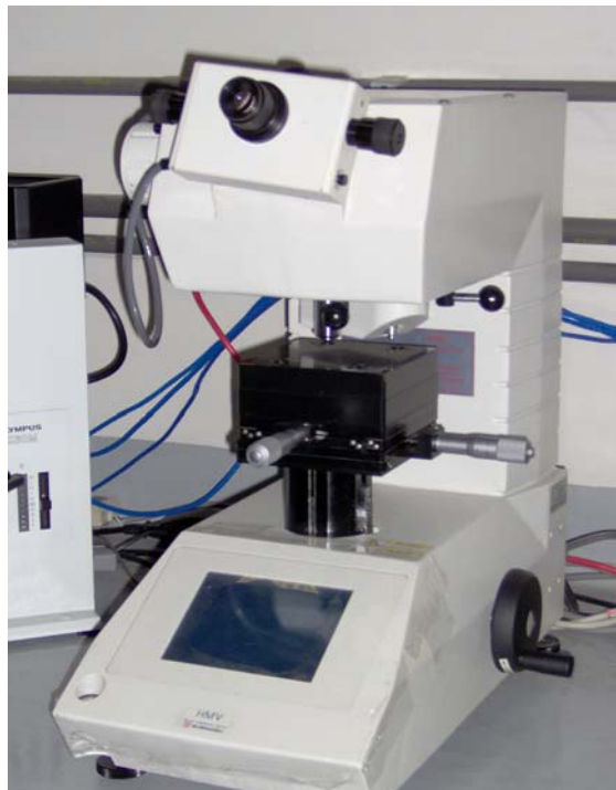
Figura 9. Microdurômetro SHIMADZU MICROHARDNESS TESTER HMV2.
