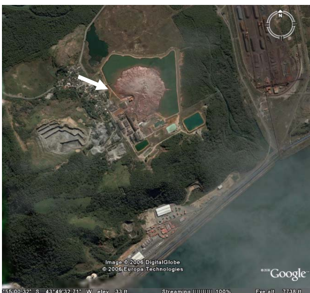
Figura A2. Cia. Ingá Mercantil. Visão área dos rejeitos contendo metais pesados e dos tanques de contenção (ao centro; indicado pela seta) e na parte inferior a direita, a Baía de Sepetiba (Porto de Itaguai). Imagem extraída do Google Earth.
