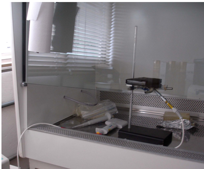
Figura 4.2 - Suporte desenvolvido para aplicação padronizada do laser nos poços (Capela de fluxo laminar com suporte para a irradiação do laser e placa pronta para ser irradiada)
