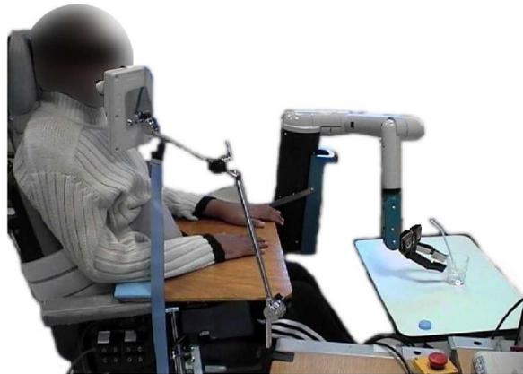
**Figura 22: Braço montado em uma cadeira de rodas.**
