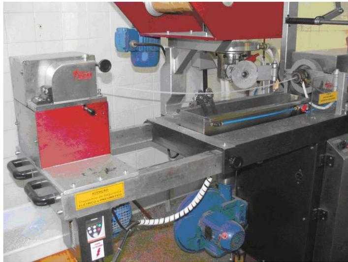
**Figura 3.1.** Produção de pellets de blenda Atp:PBAT (50:50).
