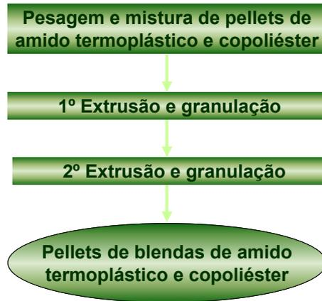
**Figura 3.3.** Fluxograma da produção das blendas de amido termoplástico e copoliéster.
