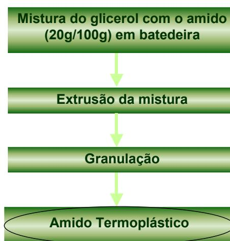
**Figura 3.2.** Fluxograma da produção do amido termoplástico.
