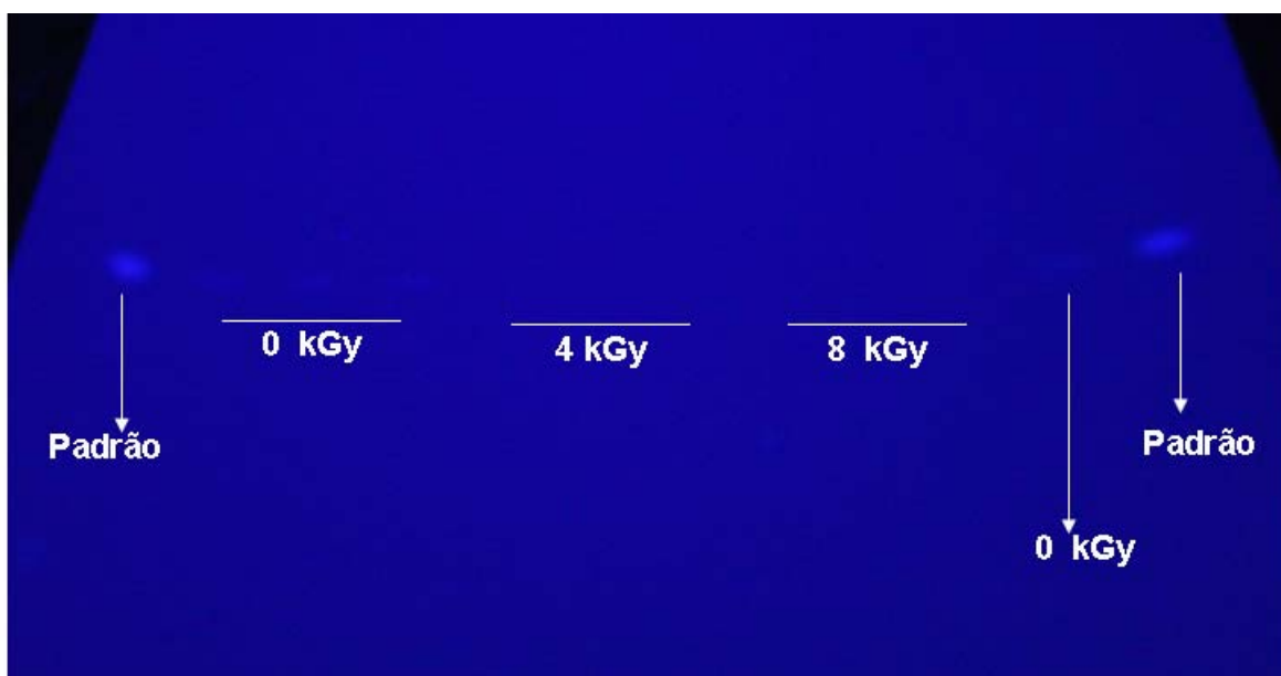
Figura 20. Cromatografia em camada delgada de AFB 1 na concentração de 500ppb (0,5 \mu\text{g ml}^{-1} ) submetido a 0, 4 e 8 kGy de radiação gama. Foi injetado 15 \mu\text{l} das amostras, três aplicações cada, e 5 \mu\text{l} do padrão de AFB 1 com 18,0645 \mu\text{g ml}^{-1} .
