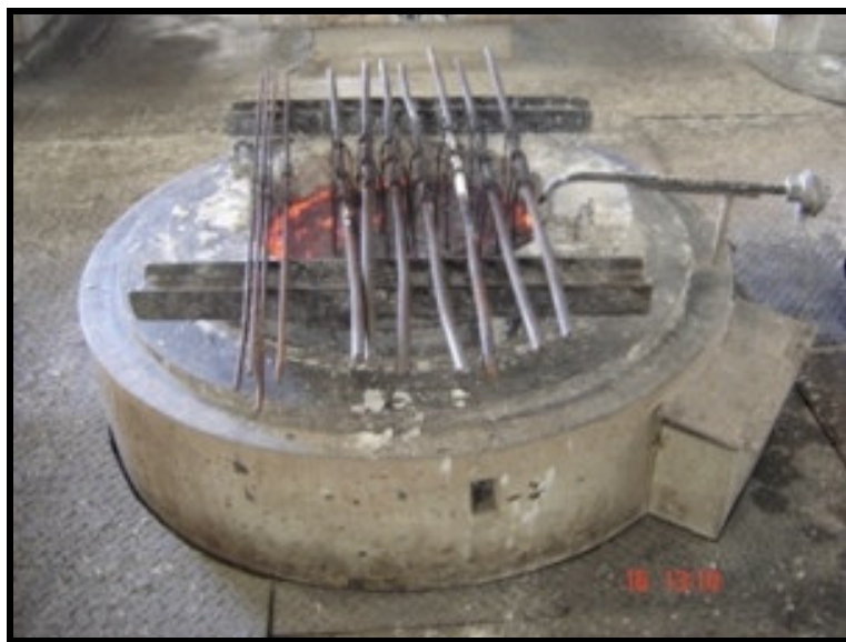
Figura 3.5. Forno banho de sal utilizado na austenitização à 850° C.
