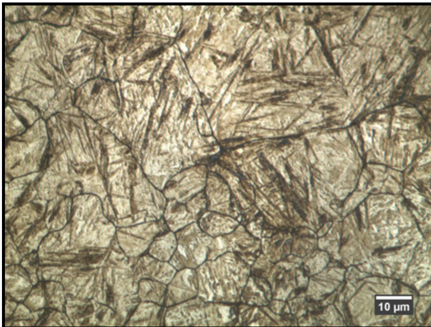
Figura 4.36. Pré-ataque com reagente Contorno de Grão e posterior ataque com reagente nital 2%. Ampliação 1000x. Condição 6 (850 °C / 286 °C / 120 s).
