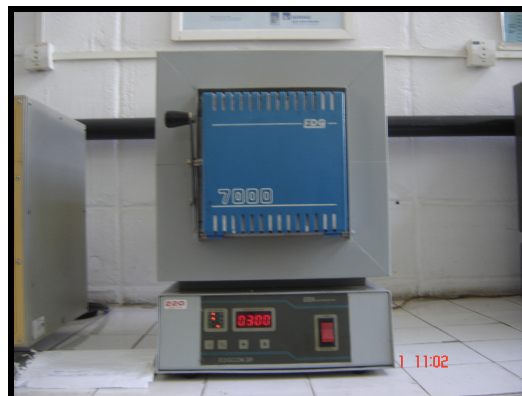
Figura 3.7. Forno mufla utilizado nos tratamentos térmicos de têmpera e revenimento.
