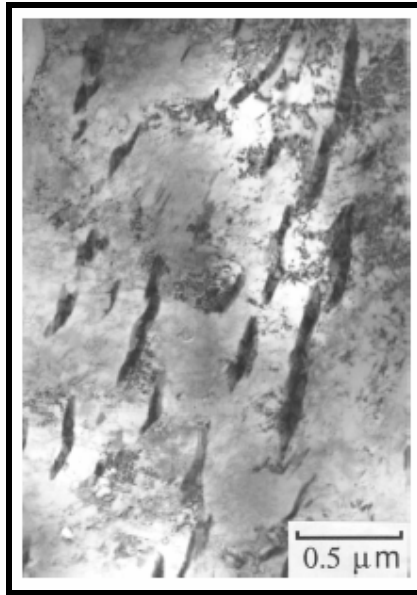
Figura 2.4. Distribuição das partículas de cementita entre as placas de bainita superior (Aço AISI 4340) (BHADESHIA, 2001).
