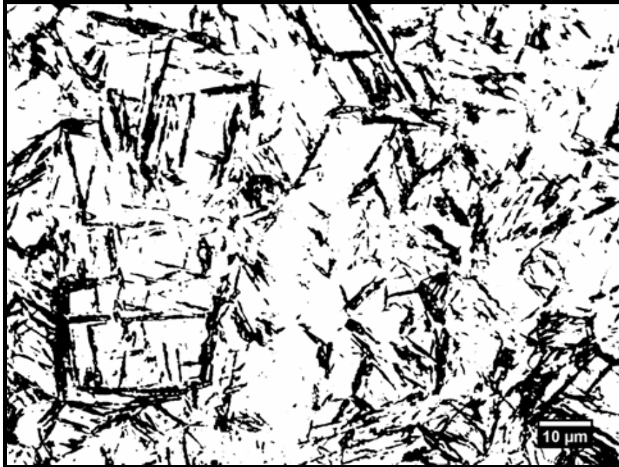
Figura 4.48. Imagem binária utilizada pelo software Image J para a quantificação da fração volumétrica. Imagem resultante da segmentação da fase bainita (área escura) e constituinte MA (regiões brancas) de uma fotomicrografia na condição 6 de tratamento térmico, obtida por meio de ataque químico com nital 2%.
