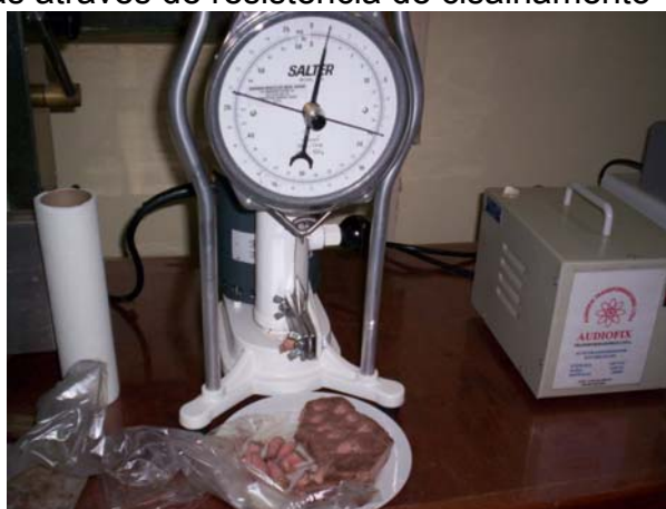
ANEXO L - Aparelho Warner-Bratzler durante realização das medidas dessas amostras através de resistência de cisalhamento
