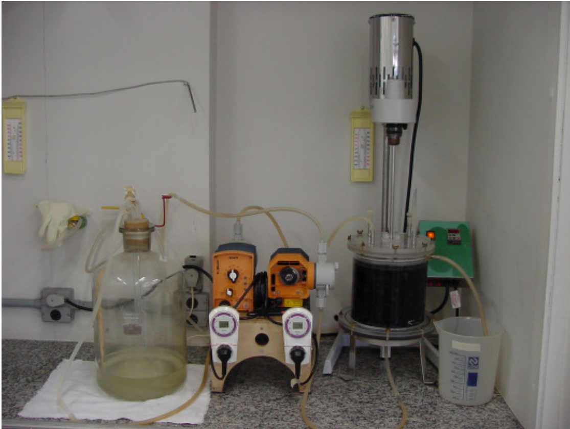
Figura 4.2 – Fotografia do reator anaeróbio operado em bateladas sequenciais contendo biomassa imobilizada
