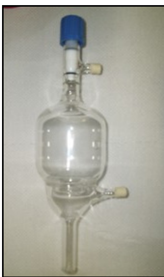
Figura 17. Fotografia de um tonômetro usado nos experimentos de estudos funcionais.
