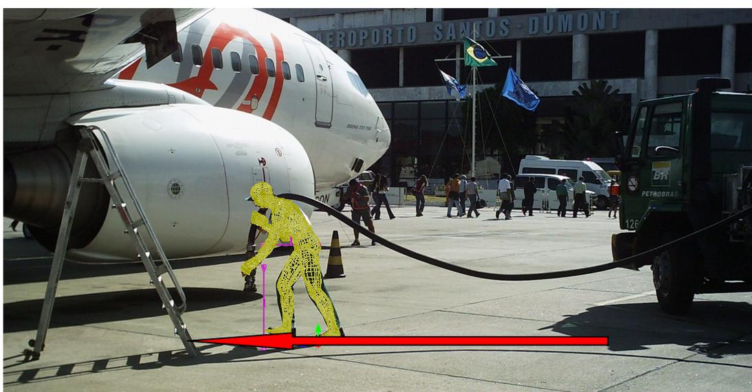
**Figura 38 – Manobra de transporte da mangueira de abastecimento na aeronave de médio porte.**
