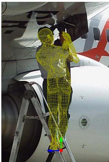
**Figura 37 – Manobra de acoplamento da mangueira de abastecimento na aeronave de médio porte.**
