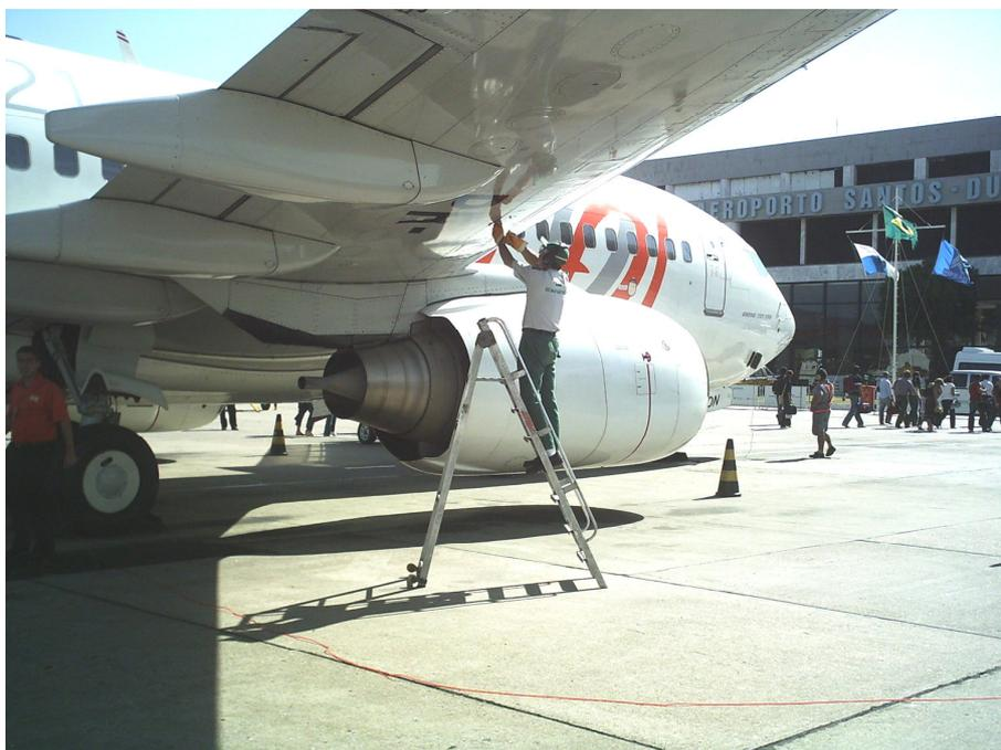
**Figura 2 – Operador de Abastecimento (OA) realizando a abertura do bocal do tanque de combustível.**
