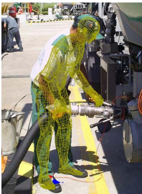
**Figura 39 – Manobra de acoplamento da mangueira de reabastecimento no CTA.**
