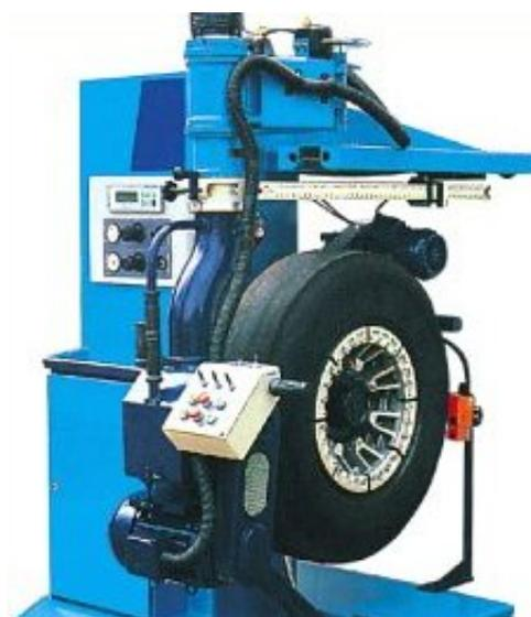
**Figura 2.3:** Recauchutagem de Pneus
