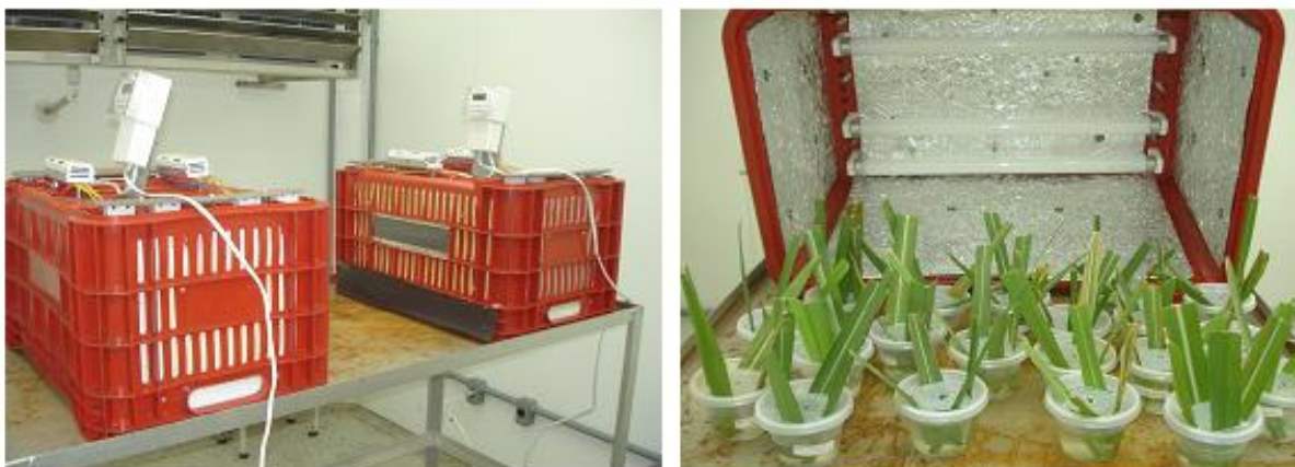
Figura 15 – Equipamentos para controle de fotoperíodo, instalados em câmara climatizada com controle de umidade e temperatura. Foto esquerda (vista geral) e foto direita (vista do interior)
