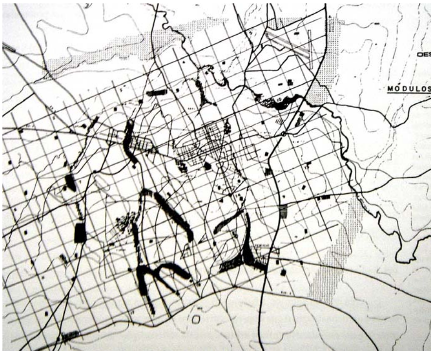
Figura 75: Malha de 1x1 km para locação de equipamentos e eixos viários. Fonte: WILHEIM, 1969a.
