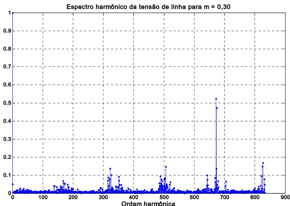
Figura 7.16 – Espectro harmônico da tensão fase-fase para  $m = 0,30$
