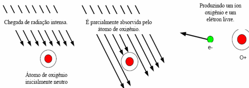
Figura 2.4 – Radiação sendo absorvida pelo átomo neutro e após ser absorvida é produzido um íon de oxigênio e um elétron livre.
