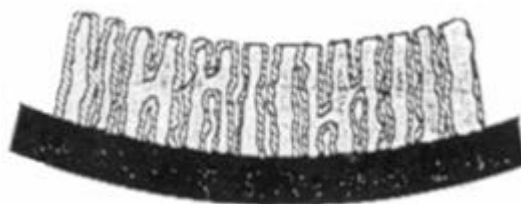
Figura 14 - Stress tensivo - filmes bastante defeituosos (MACKENZIE, 1991).
