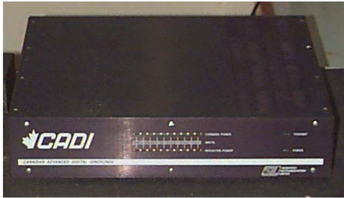
Figura 2.5 Sistema de transmissão da ionossonda digital tipo CADI.
