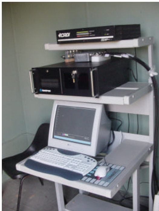
Figura 2.6 Ionossonda digital tipo CADI.
