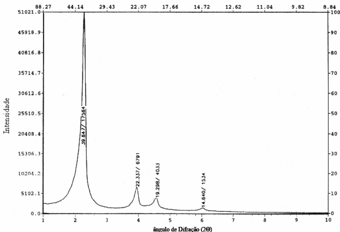
**Figura 2.2** – Difratograma de difração de raios X da Si-MCM-41 sintetizada com CTMA-Br e calcinada a 600°C por 12 horas (OCCELLI & BIZ, 2000).
