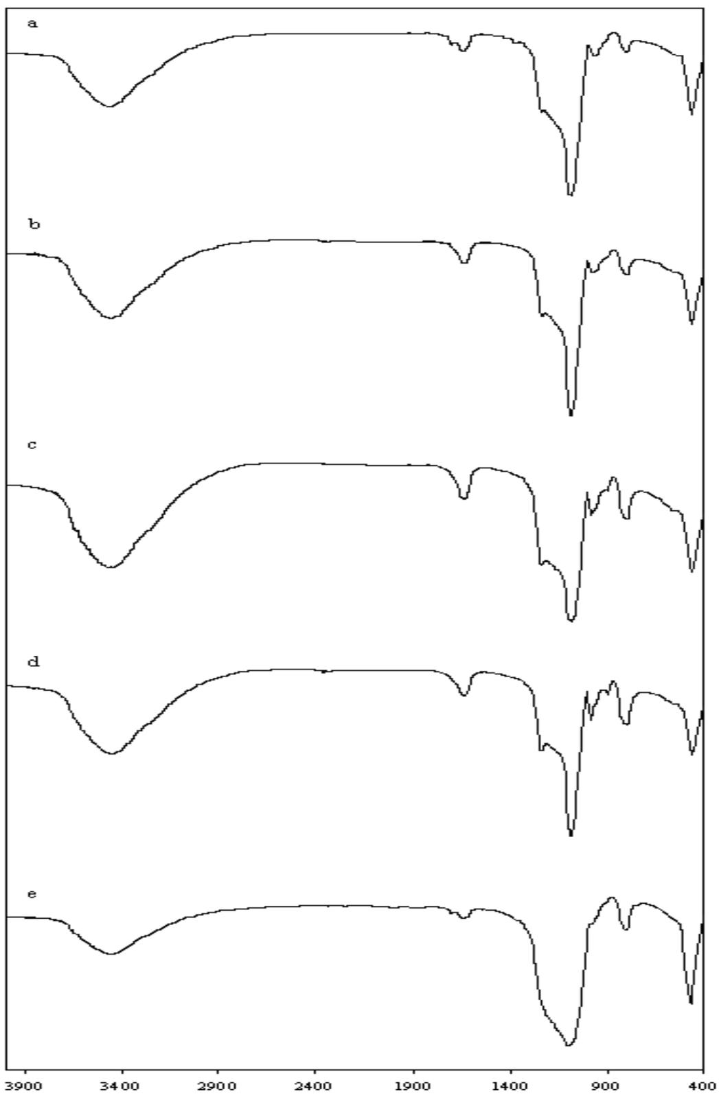
**Figura 4.10** – Espectro no infravermelho da amostra de Si-MCM-41(150°C/2d): (a) pura, (b) 15% de HPA, (c) 30% de HPA, (d) 45% de HPA e (e) Zircônia.
