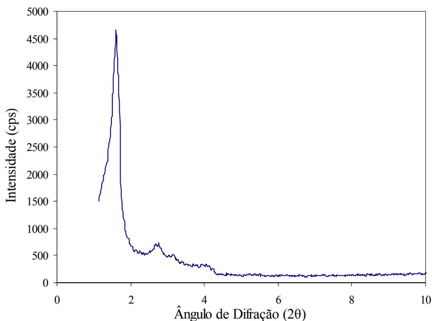
**Figura 4.1** – Difratograma de raios X da amostra MCM-41(150°C/2d)
