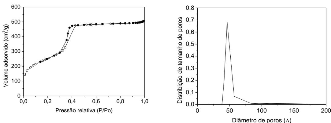
**Figura 4.11** – Isotherma de adsorção (símbolos vazios) e dessorção (símbolos cheios) de nitrogênio sobre a amostra MCM-41 calcinada e sua distribuição de tamanho de poros pelo método de Broekhoff-deBoer utilizando a equação de Frenkel-Halsey-Hill.
