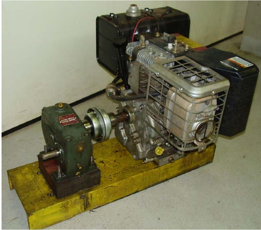
FIGURA 4. 2 - Bancada construída com o motor Briggs & Stratton
