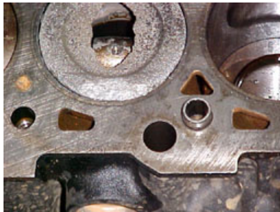
FIGURA 2. 2 - Danificação por detonação
