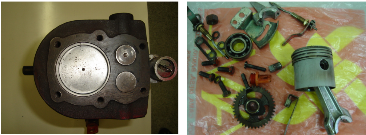
FIGURA 5. 4 – Fotos do Motor Montgomery após o teste. Esquerda, pistão danificado; direita, partes principais desmontadas.
