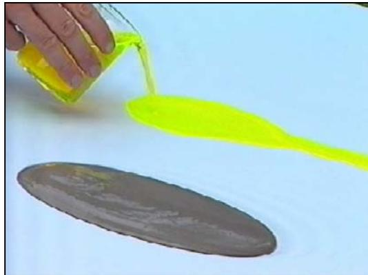
**Figura 9:** Escoamento de lama (não-Newtoniana) e água com corante (Newtoniana).
