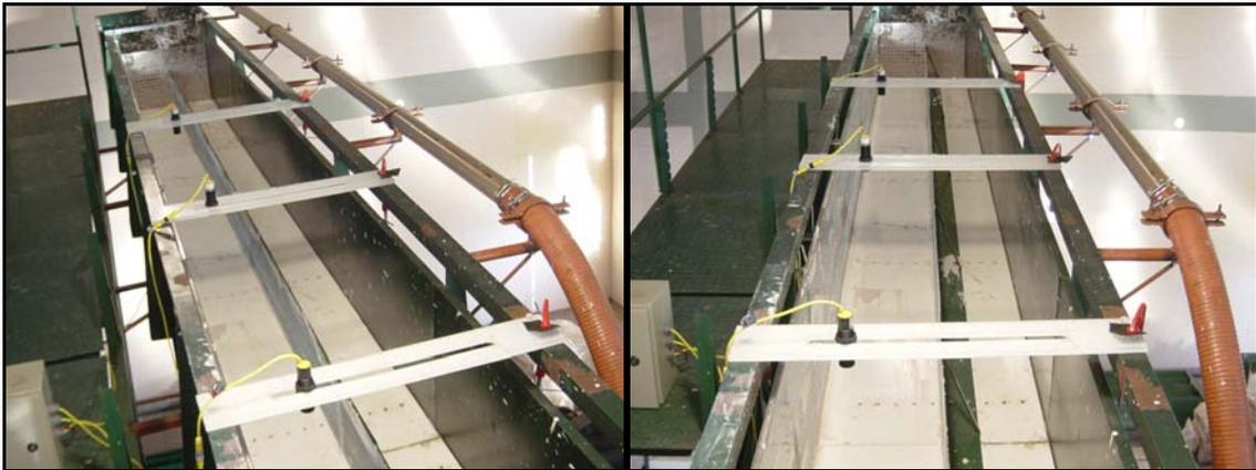
**Figura 45:** Plataforma equipada com sensores ultrasônicos e septo divisorio na seção.
