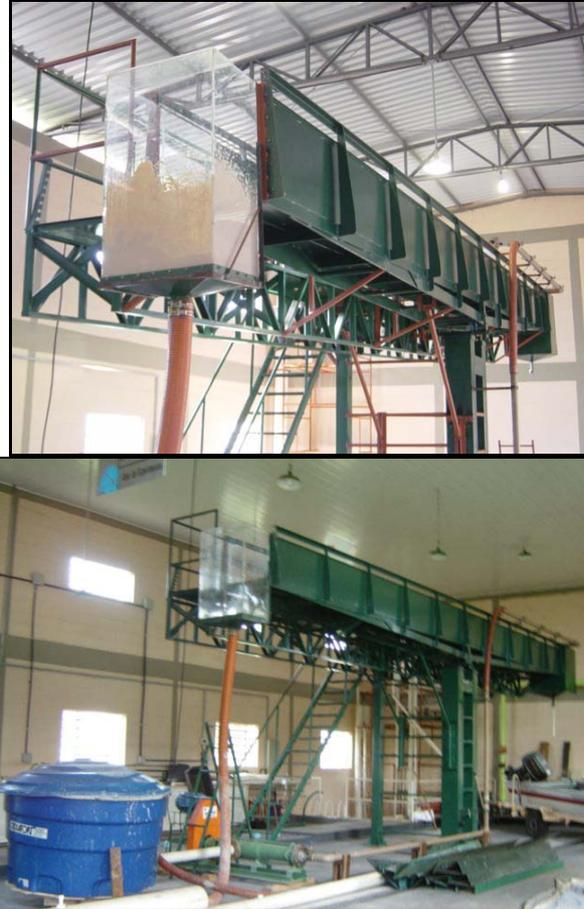
**Figura 44:** Plataforma de ensaios de lama.
