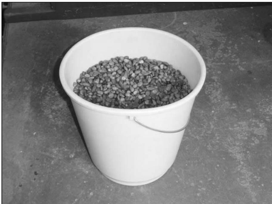
Figura 4.12 - Seixo rolado tipo 2 ( $9,5 < d < 12,5$  mm).
