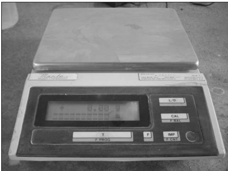
Figura 4.13 - Balança digital utilizada para medir a massa das amostras.
