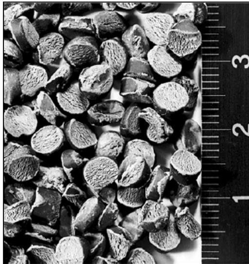
Figura 3.12 - Material granular utilizado por Fritz (2002) para a geração de ondas de deslizamento.
