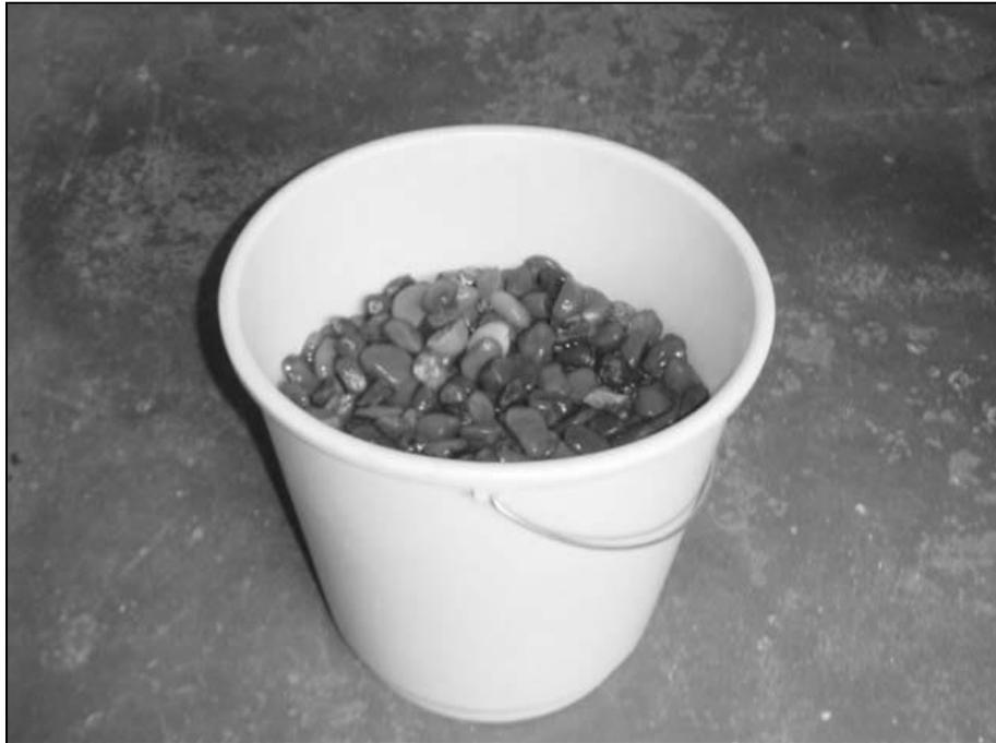
Figura 4.11 - Seixo rolado tipo 1 ( $12,5 < d < 19$  mm).
