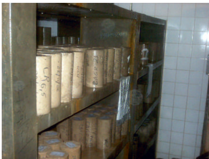
Figura 5.21 – Acondicionamento dos corpos-de-prova em câmara úmida.
