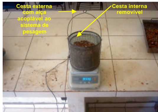
Figura 5.8 – Aferição de massa da amostra seca do AGR.
