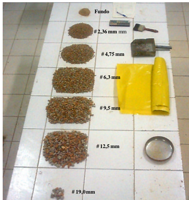
Figura 5.5 – Ensaio de determinação da composição granulométrica do AGR.
