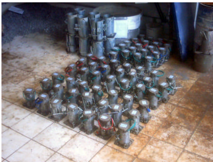
Figura 5.20 – Moldagem dos corpos-de-prova.
