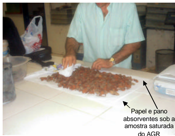
Figura 5.10 – Remoção da água excedente da amostra saturada do AGR.
