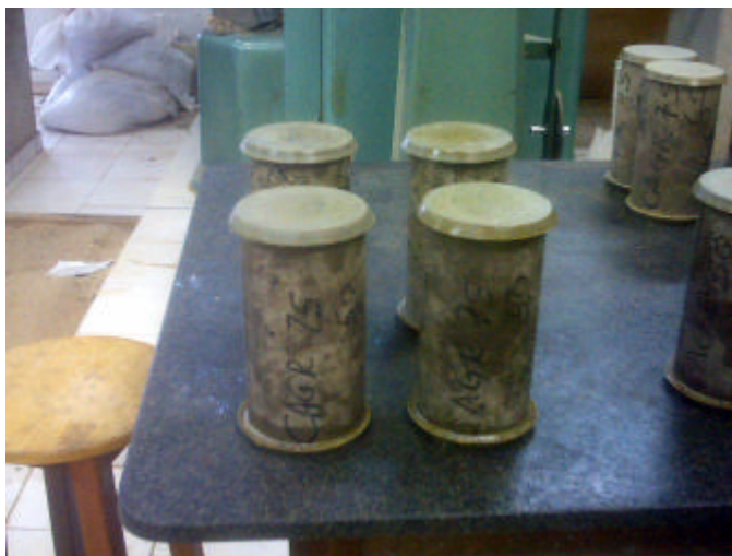
Figura 5.22 – Aspecto geral dos capeamentos de enxofre.
