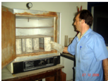
Figura 5.29 – Secagem dos corpos-de-prova em estufa para ensaio de absorção.
