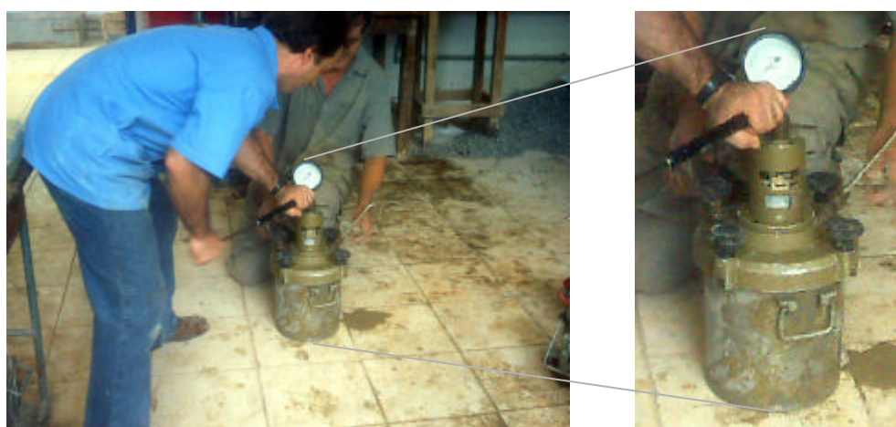
Figura 5.19 – Determinação do teor de ar incorporado pelo método pressométrico.
