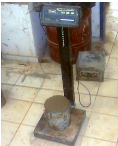
Figura 5.18 – Medida da massa específica do concreto fresco.
