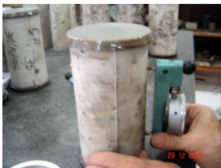
Figura 5.27 – Fixação do extensômetro no corpo-de-prova.
