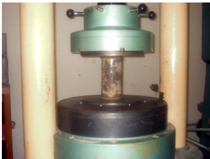
Figura 5.23 – Ensaio de resistência à compressão uniaxial.
