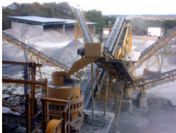
Figura 2.7 – Sistema de britagem (bica corrida) da prefeitura de Goiânia-GO (2005).
