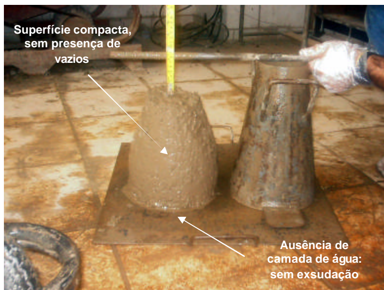
Figura 5.14 – Medida da consistência e aspecto geral do concreto com AGR.
