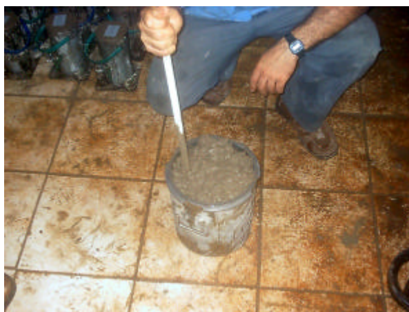
Figura 5.15 – Adensamento do concreto para ensaio de massa específica.
