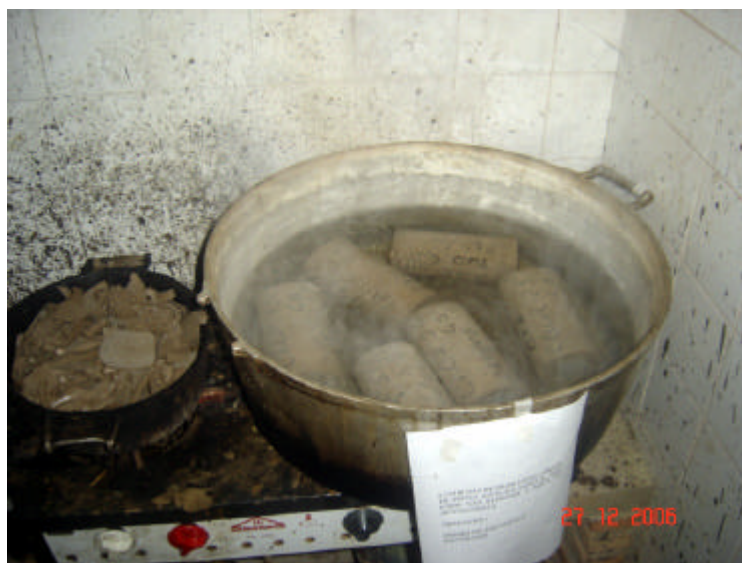
Figura 5.31 – Imersão de corpos-de-prova em água fervente.
