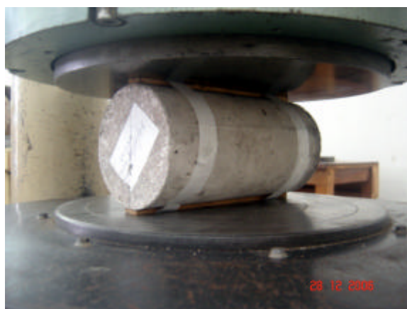
Figura 5.25 – Execução do ensaio de tração por compressão diametral.
