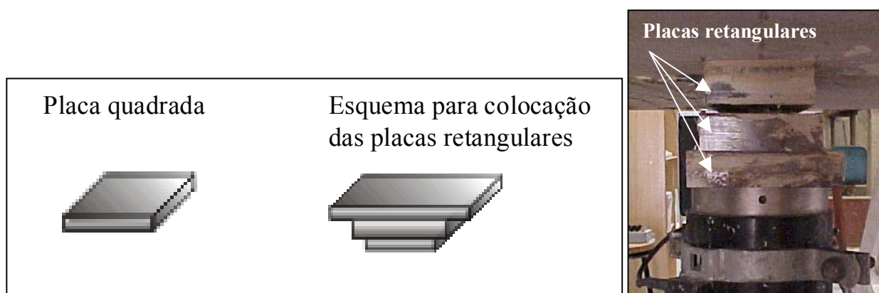
Figura 3.4 – Esquema das placas e fotografia para aplicação de carga
