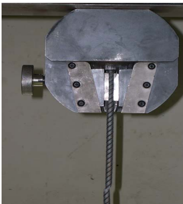
Figura G.12 – Aço rompido na prensa
