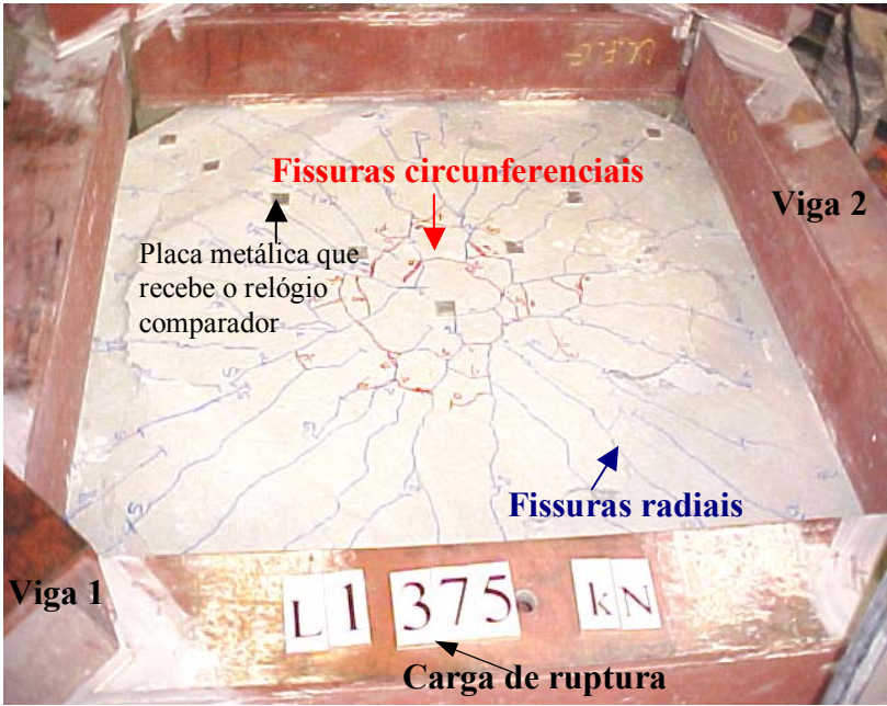
Figura 4.27 – Fissuração da laje L1
