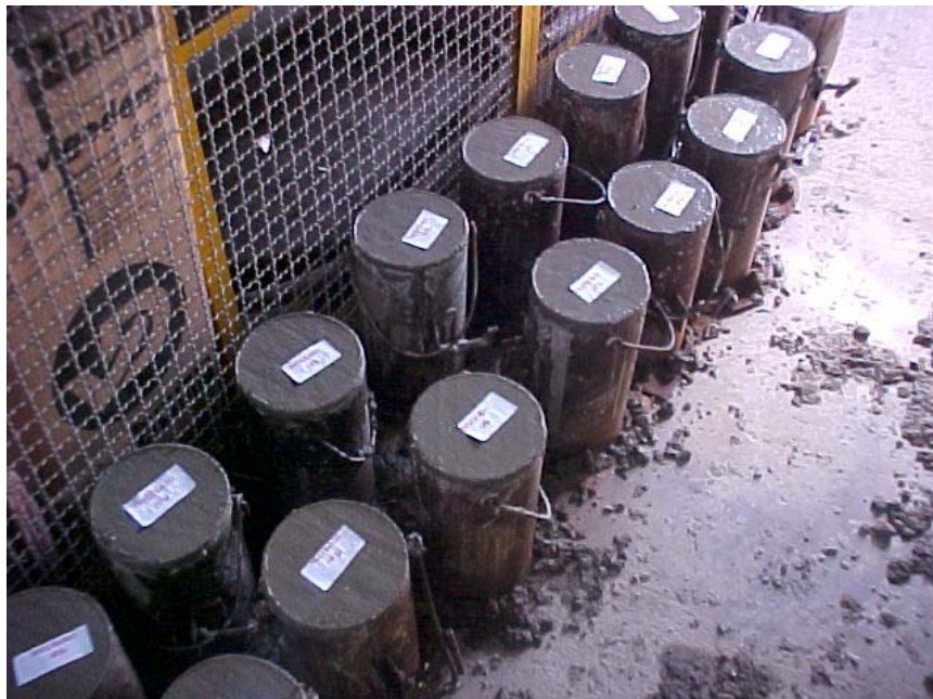
Figura G.5 – Corpos-de-prova moldados
