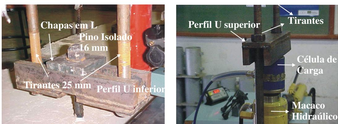
Figura 3.5 – Fotografia dos perfis U, inferior e superior
