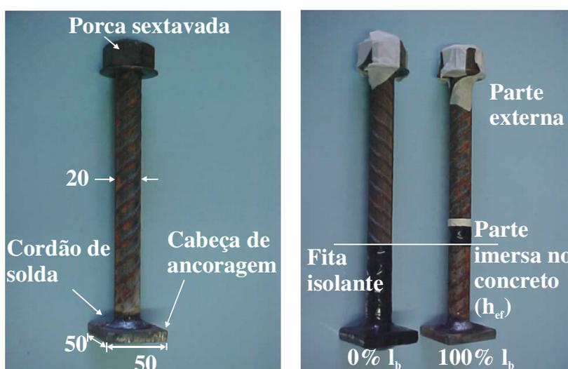
Figura 3.10 – Configuração dos pinos preparados para concretagem
