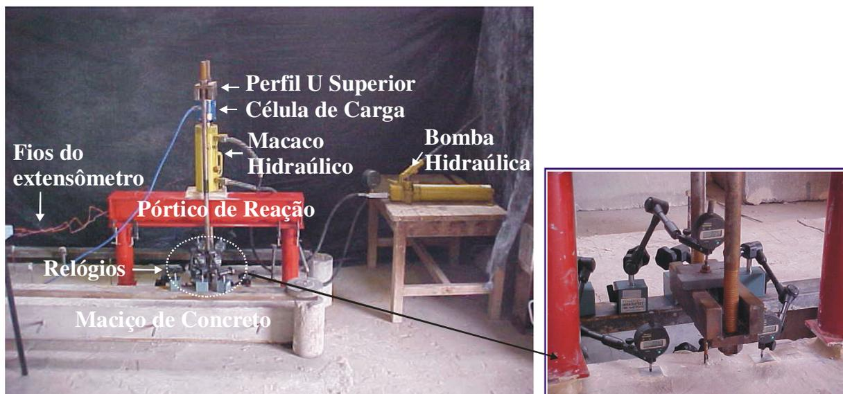
Figura 3.8 – Fotografia do esquema de ensaio com pórtico de dois apoios.
