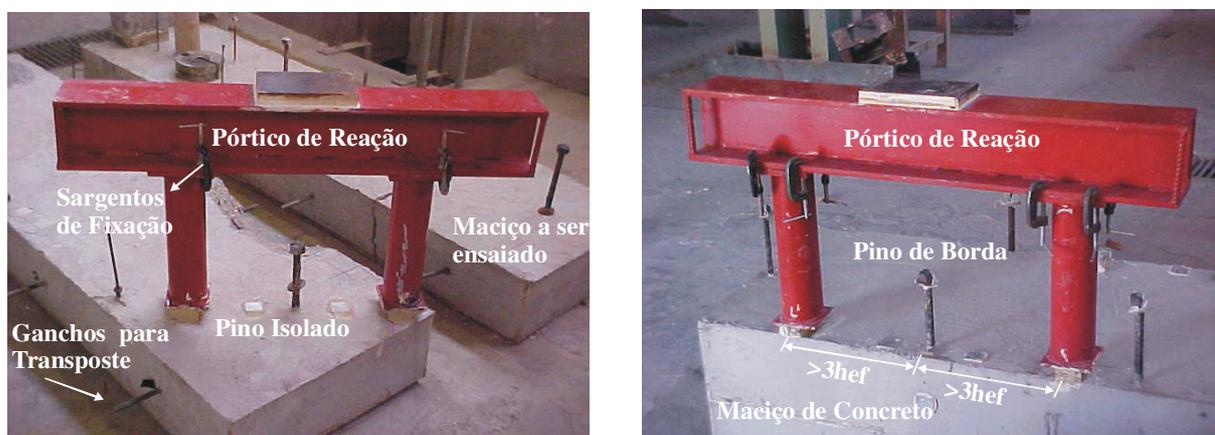
Figura 3.17 – Fotografia do pórtico posicionado para situações de borda e pinos centrais
