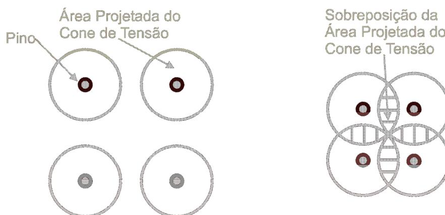
Figura 2.17 – Exemplo da sobreposição dos cones.
