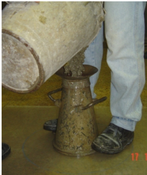
Figura 6. 3 - Preenchimento do cone para realização do ensaio de espalhamento
