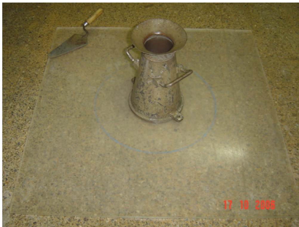
Figura 2. 7 - Equipamento para realização do ensaio de espalhamento
