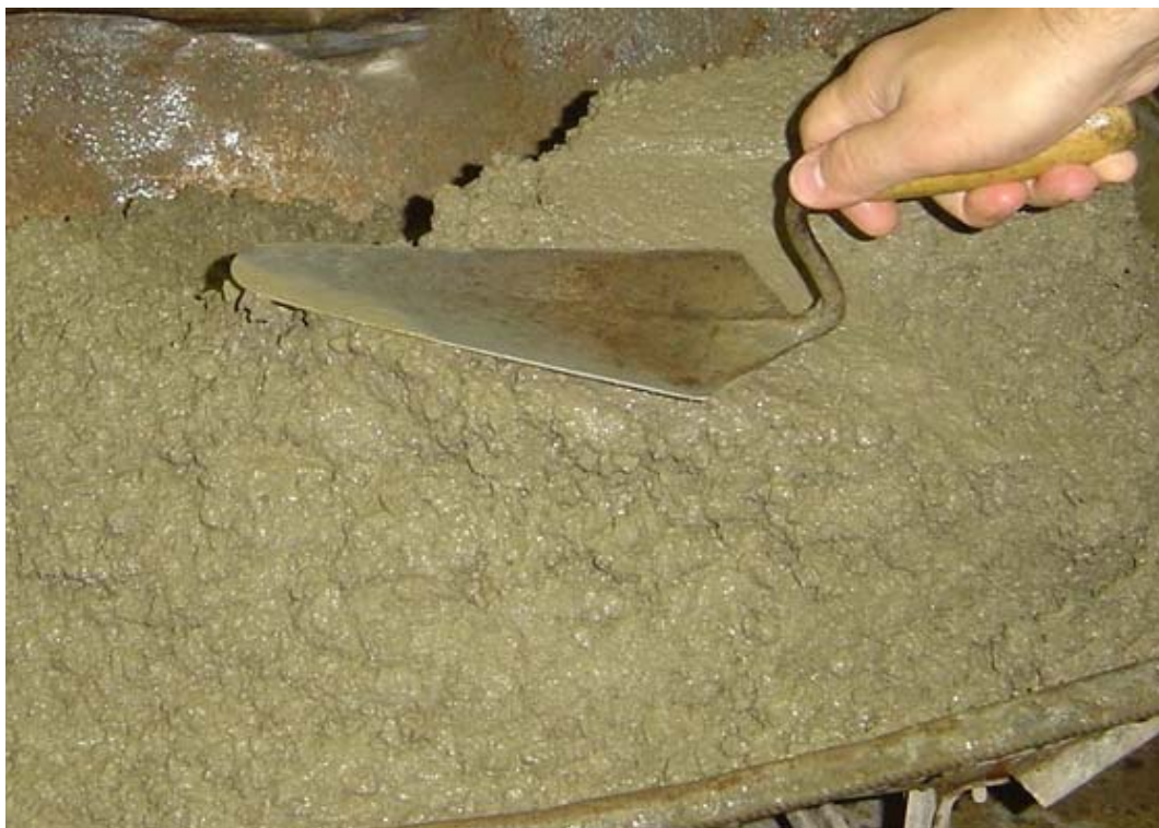
Figura 6. 2 - Teor ideal de argamassa, com bom acabamento (56%)
