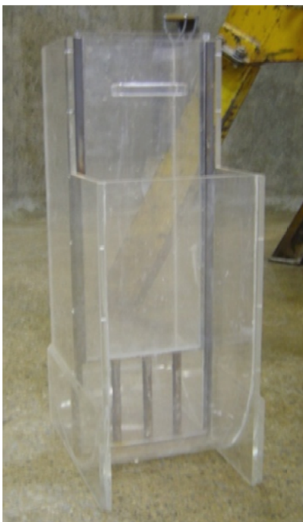
Figura 2. 8 - Vista frontal da Caixa U
