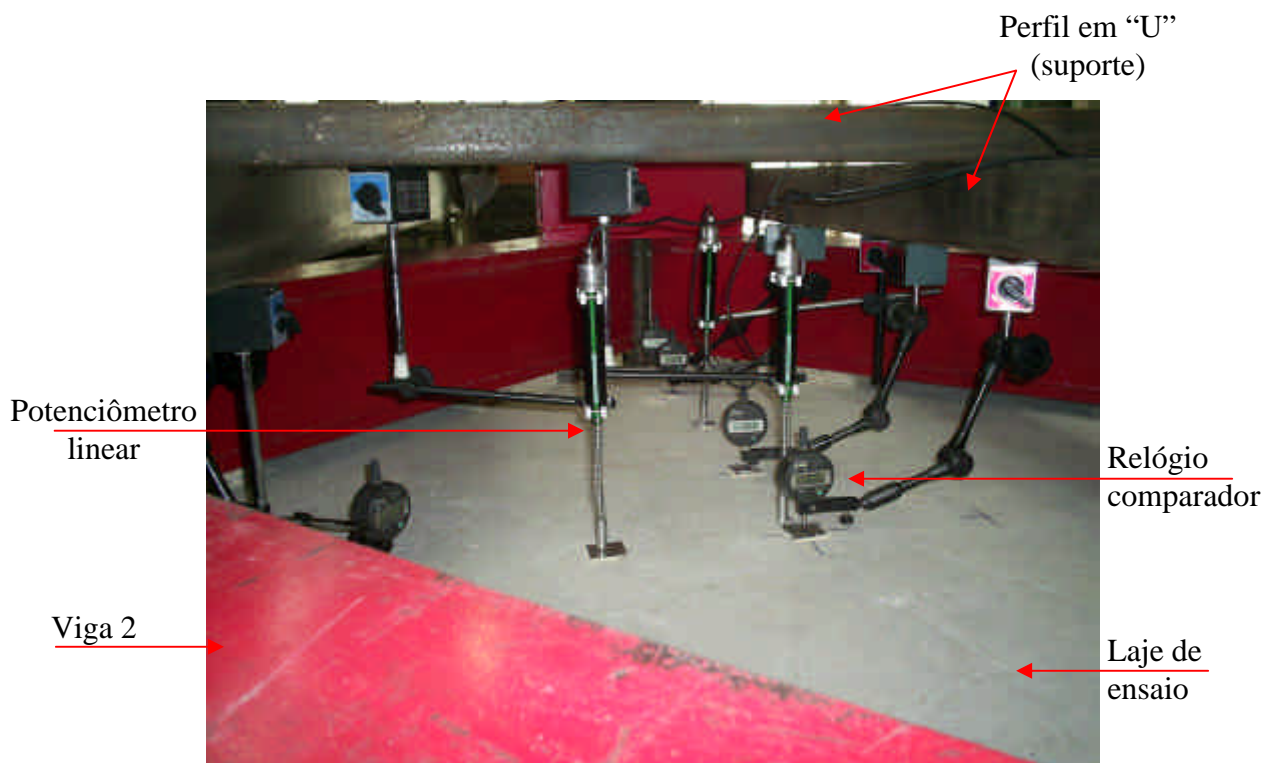
Figura 3.11 – Fixação dos relógios comparadores e potenciômetros
