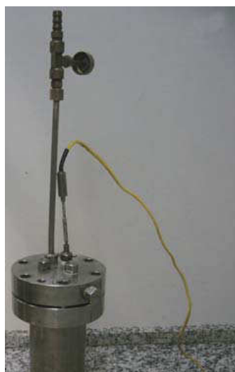
FIGURA 3.1: Sistema convencional de hidrotermal 55
