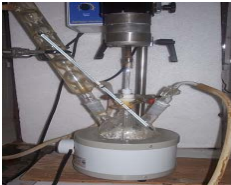
Figura 2.2 - Esquema do sistema reacional para modificação da sílica gel com 3-APTS.
