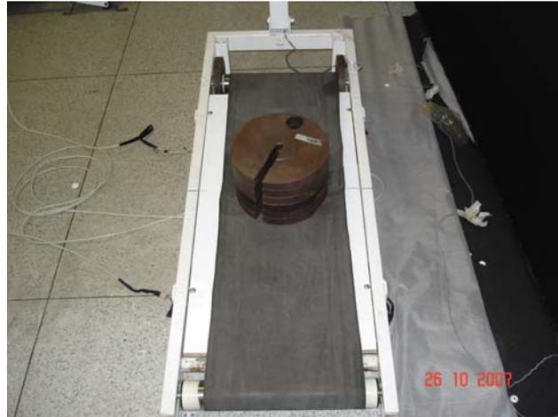
Figura 3.15 – Calibração vertical dos canais pares da plataforma
