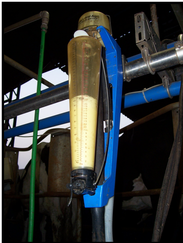
Figura 4 – Equipamento utilizado para medir e coletar a mostra de leite
