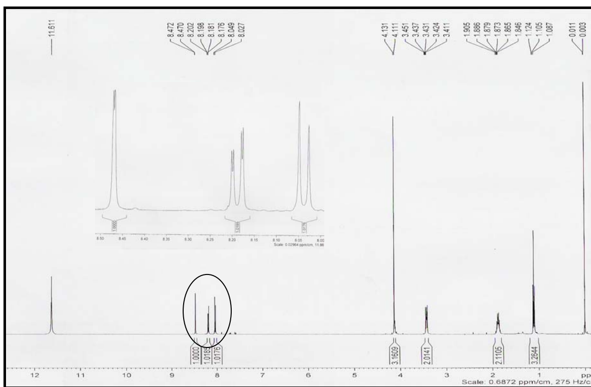
FIGURA 4.9: Espectro de RMN- ^1H para o albendazol-sulfona
