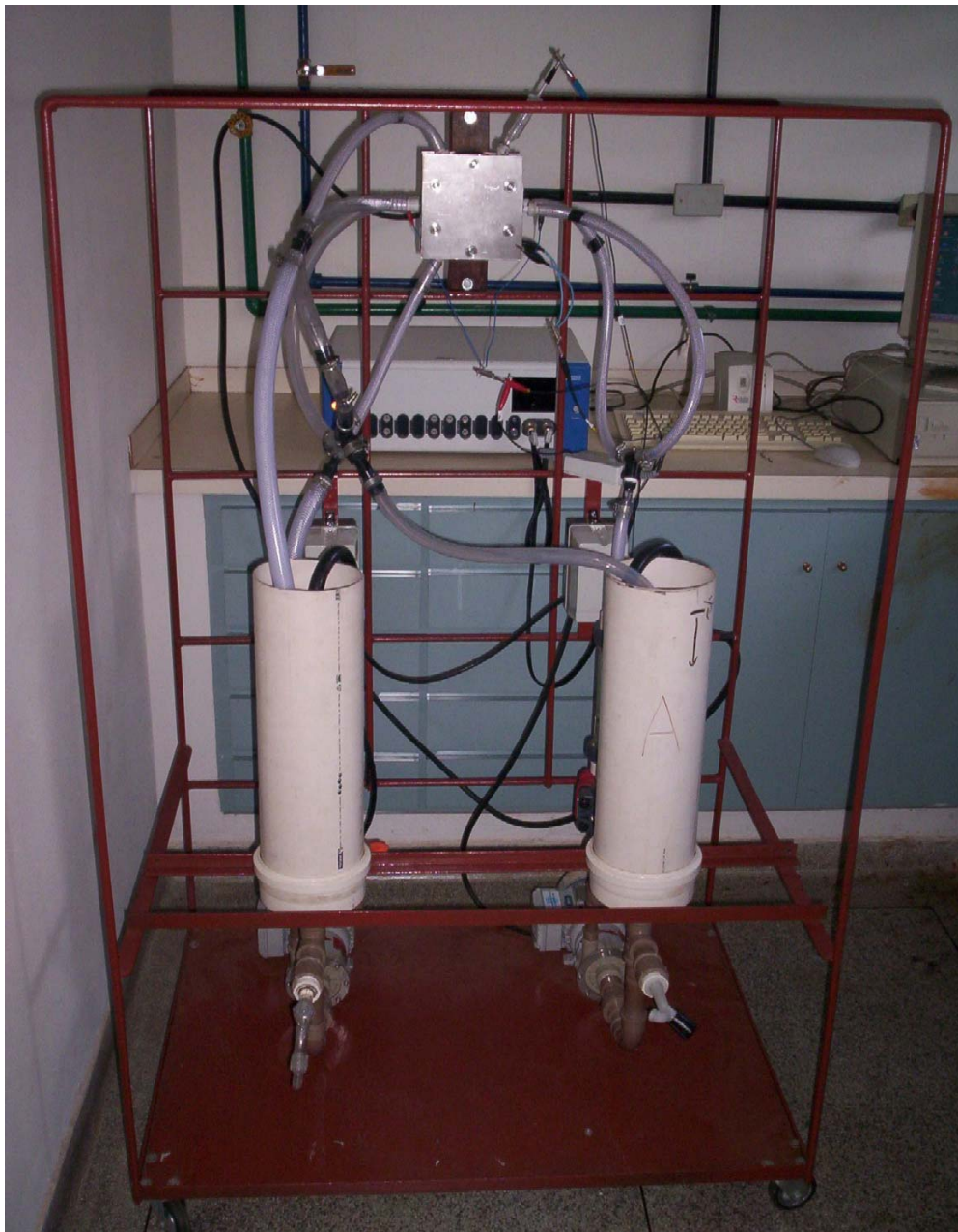
FIGURA 3.2 – Foto frontal do sistema eletrolítico completo utilizado nos experimentos de remoção eletrolítica de Pb(II) de efluentes simulados.
