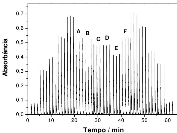
**Figura 4.9** Sinais transientes das soluções padrão (2,0; 5,0; 8,0; 11 e 14 mg L<sup>-1</sup>) e das amostras em triplicatas.
