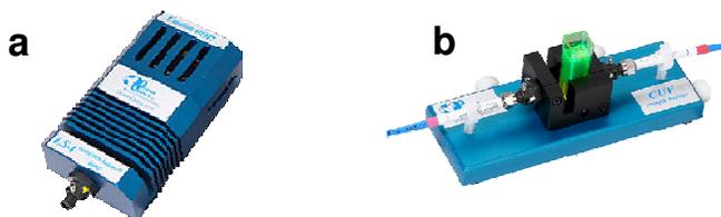
**Figura 3.3** Representação dos equipamentos empregados para medidas espectrofotométricas, na determinação de hipoclorito em alveijantes, sendo (a) Fonte de radiação – lâmpada de tungstênio-halogênio; (b) Célula de 1,0 cm de caminho óptico.
