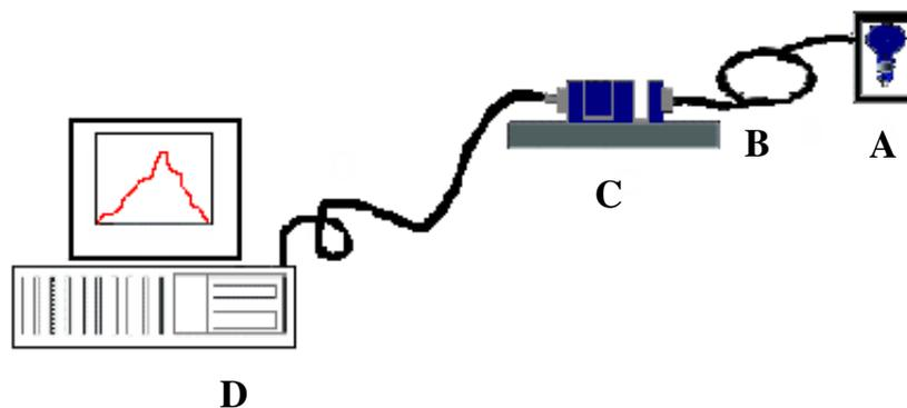
**Figura 3.2** Esquema do sistema usado na determinação de hipoclorito em alveijantes, sendo (A) fonte de radiação; (B) fibra óptica que serve como guia de radiação; (C) célula de 1,0 cm de caminho óptico; (D) espectrofotômetro PC 2000 fiber-optic, localizado dentro da CPU.
