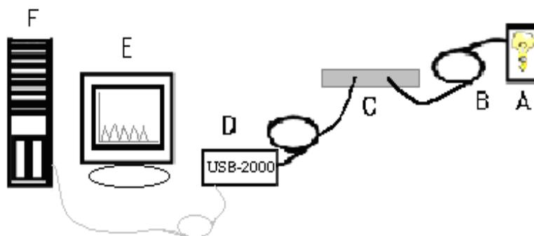
**Figura 3.5** Diagrama do sistema usado na determinação de cloro, em águas de abastecimento, sendo (A) fonte de radiação, (B) fibra óptica que serve como guia de radiação, (C) célula de 100 cm de caminho óptico (LPC-1) da Ocean Optics e (D) espectrofotômetro USB 2000 FL; (E) monitor e (F) CPU.
