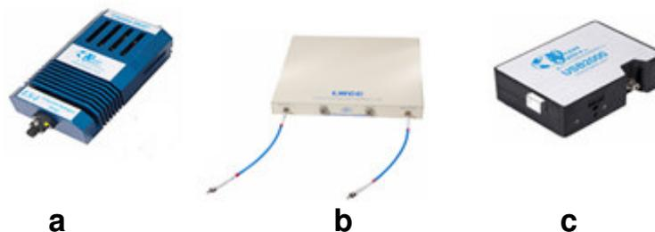
**Figura 3.6** Representação dos equipamentos empregados para medidas espectrofotométricas, na determinação de cloro em águas de abastecimento, sendo (a) fonte de radiação–lâmpada de tungstênio-halogênio, (b) célula de 100 cm de caminho óptico e cabos de fibra óptica com fendas de 600 e 50  $\mu\text{m}$  e (c) espectrofotômetro USB2000.
