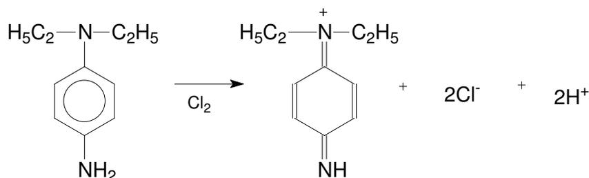
**Figura 2.5** Oxidação do DPD e seu produto estabilizado por ressonância<sup>36</sup>.
