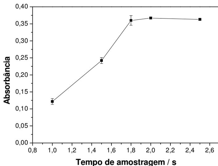
**Figura 4.3** Efeito do tempo de amostragem sobre o sinal analítico, n=3.
