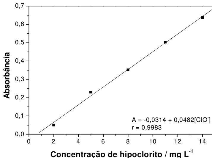
**Figura 4.8** Curva analítica obtida para determinação de hipoclorito em alvejantes (2,0; 5,0; 8,0; 11 e 14 mg L<sup>-1</sup>), n=3.
