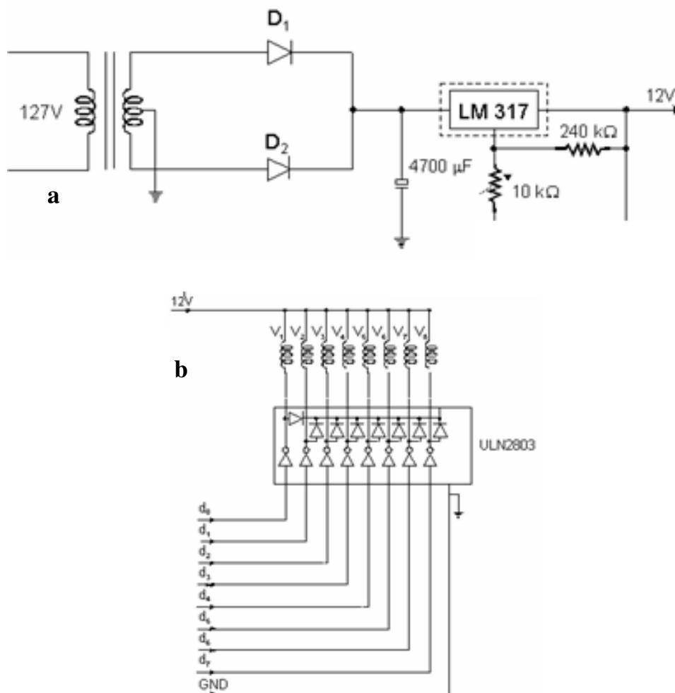
**Figura 3.1** Representação dos circuitos eletrônicos empregados para o acionamento das válvulas solenóides. a) Fonte de diferença de potencial constante (12 V).  $D_1$ ,  $D_2$ —diodos; LM 317 - regulador de voltagem. As linhas pontilhadas representam placas metálicas usadas para dissipação de calor. b) Interface de potência (*driver* de corrente):  $d_0$ - $d_7$  - linhas de saída digital da interface PCL-711S;  $V_1$ - $V_8$  - válvulas solenóides; ULN2803 - circuito integrado; GND - terra.
