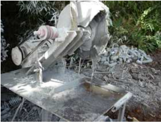
FIGURA 30 – Serra para bloco de concreto.
