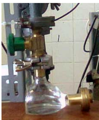
Figura 3.2: Alvo conectado à bomba mecânica.
