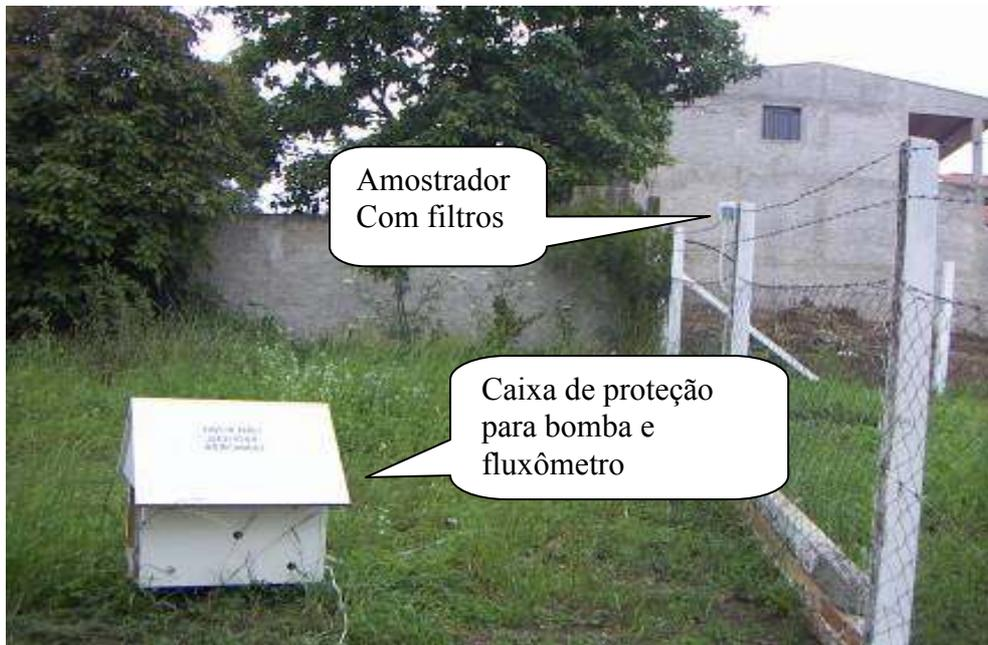
Figura 11 – Sistema de amostrador instalado no ponto A
