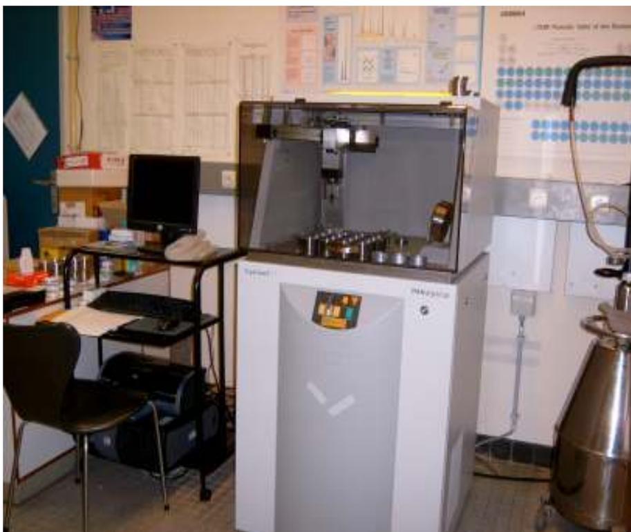
Figura 14 - equipamento Epsilon 5 HE-P-EDXRF, PANALYTICAL
