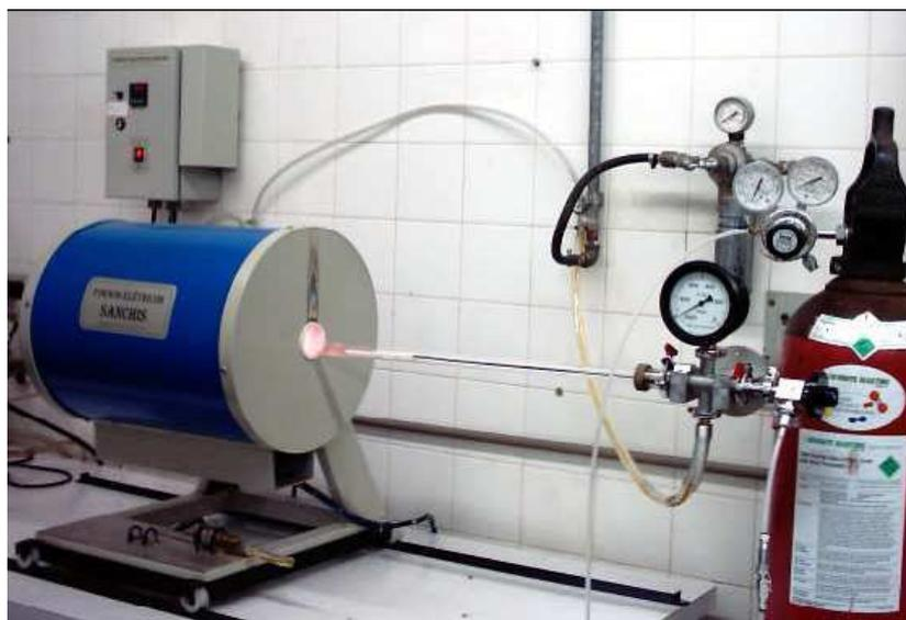
**Figura 3.5 – Forno tubular utilizado para o tratamento térmico.**
