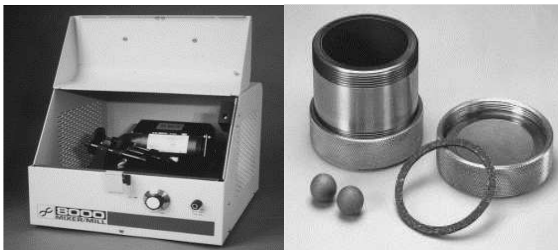
Figura 3.3: Moinho Spex e vaso de moagem (BIONDO, 2005).
