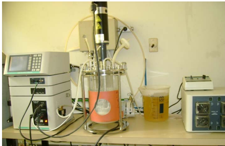
Figura 2.1 – Configuração do fermentador para o experimento em batelada alimentada.
