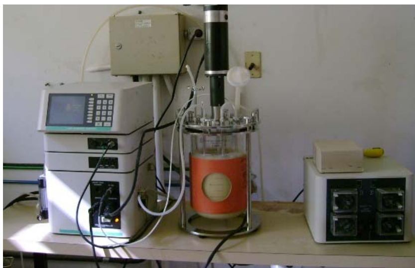
Figura 3.2 – Configuração do fermentador para o experimento em batelada.
