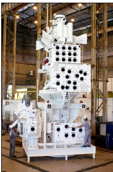
Figura 6: Árvore de Natal GLL-5, para uma profundidade de 2500 metros.
