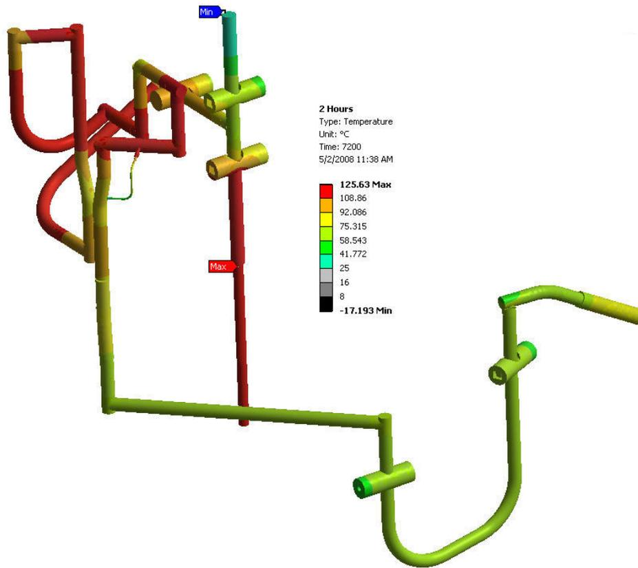
Figura 48: Temperaturas do gás após 2 horas de parada de produção – Concepção 2.
