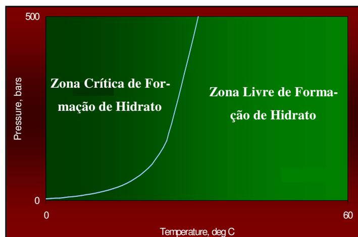
Figura 14: Gráfico pressão x temperatura - regiões crítica e livre de formação de hidrato.
