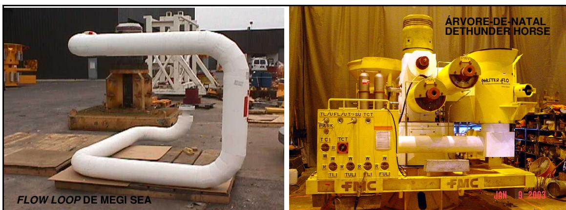
Figura 18: Aplicação do isolamento Novolastic HT.
