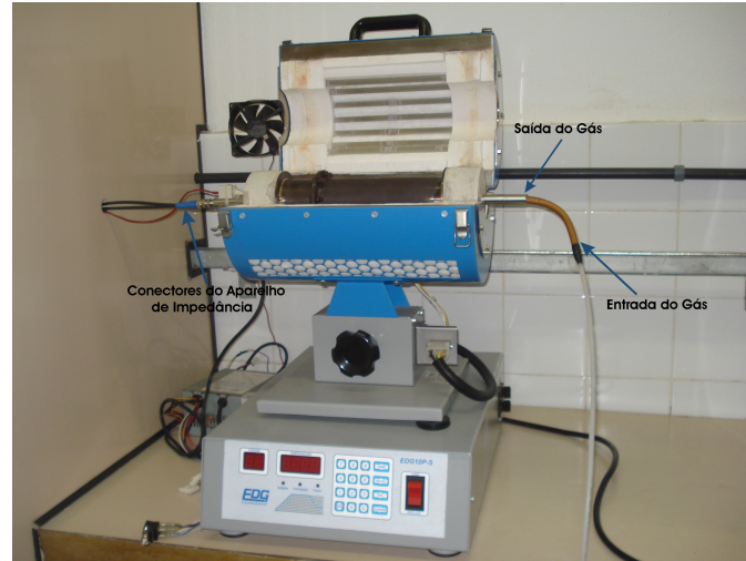
Figura 4.9: Forno EDG10P – S , utilizado para variar a temperatura da amostra.
