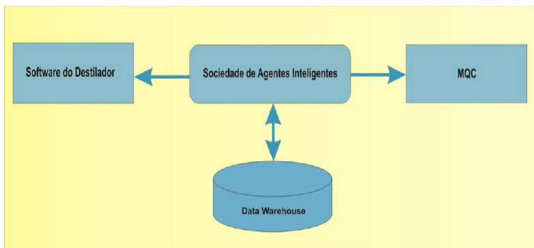
Figura 25: Modelo da tecnologia de agente inteligente proposto no processo de monitoramento de combustível.
